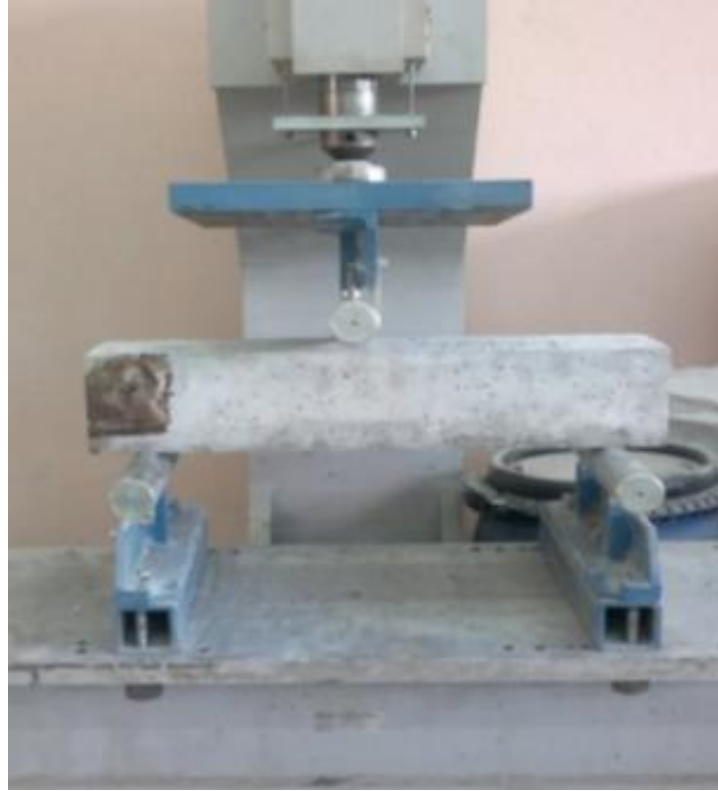
Şekil 5.7. Eğilme çekme deneyi
