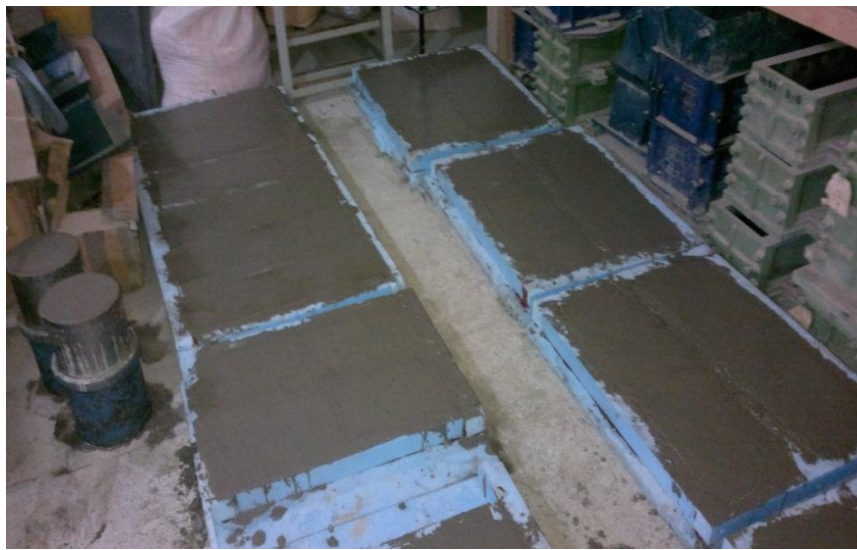
Şekil 5.3. Numunelerin kalıplara yerleştirilmesi
