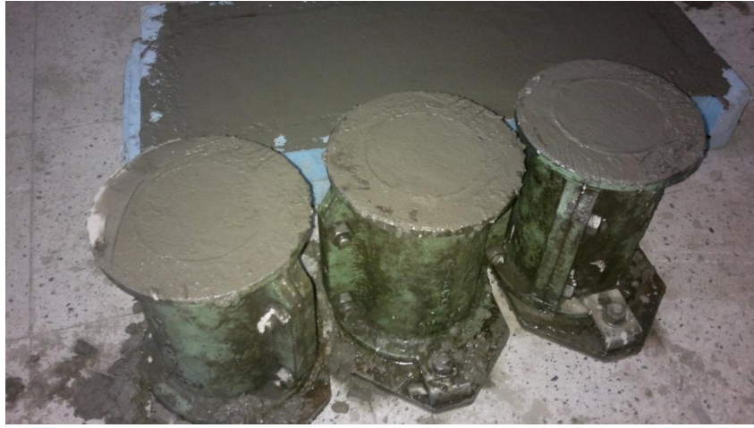
Şekil 5.2. Yarmada çekme deney numuneleri
