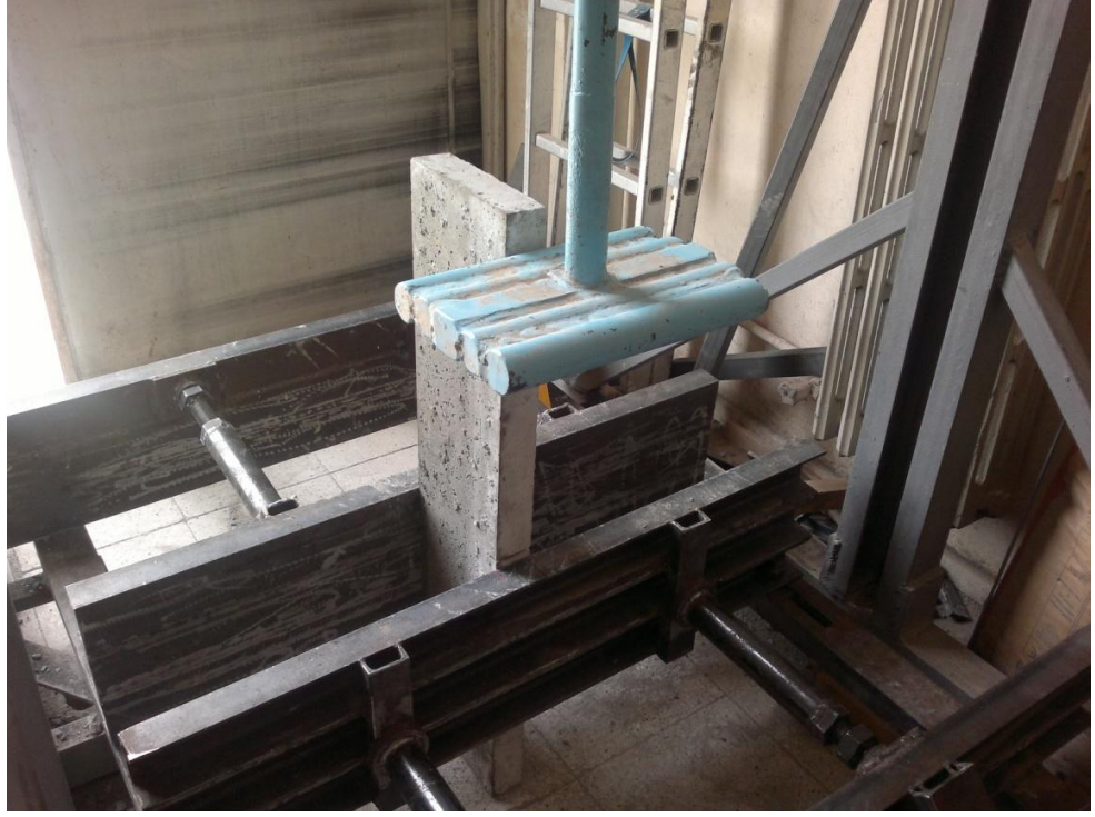
Şekil 5.9. İzod deney düzeneği ve numunenin yerleştirilmesi
