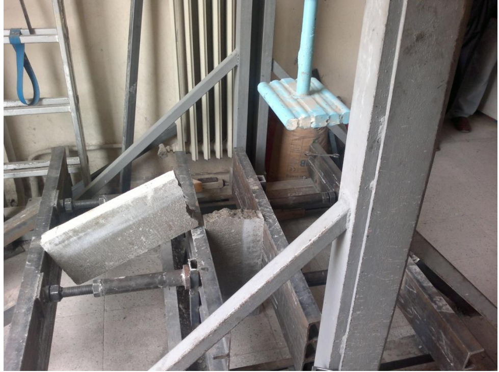
Şekil 5.10. İzod deney düzeneği ve numunenin yerleştirilmesi
