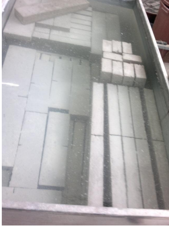
Şekil 5.4. Numunelerin kür tankında bekletilmesi.
