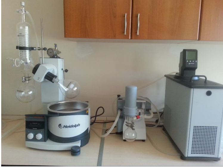
Şekil 3.3. Vakumlu evaporatör düzeneğinin görünümü
