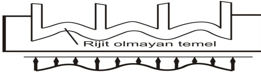
Şekil 3.3. Radye temelini zemine göre rijit olmadığı durumlarda taban basıncı dağılımı (Doğangün, 2008).
