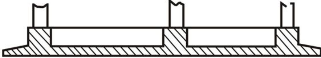
Şekil 3.6. Kirişli radye jeneral temel uygulaması (Çamlıbel, 2000)
