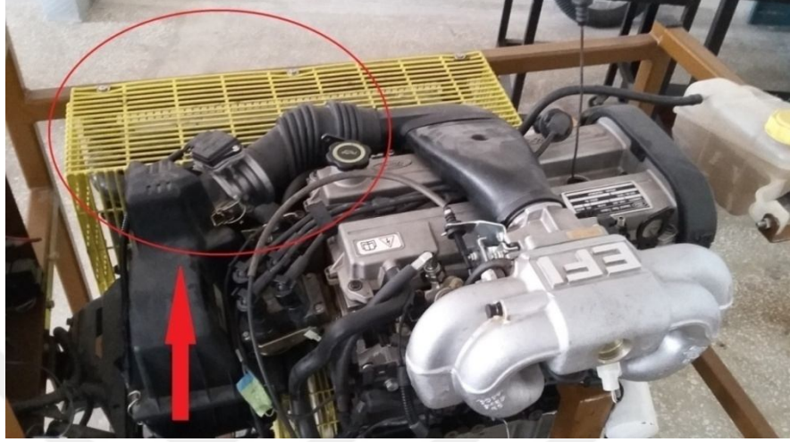
Şekil 2.3. Deney motoruna ait olan radyatör muhafaza ızgaraları
