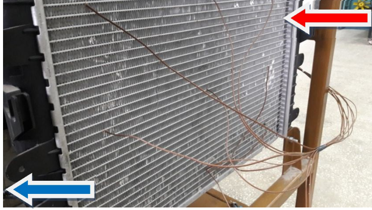
Şekil 2.5. Gerçekte radyatör yüzeyine termokuplların monte ediliş biçimi
