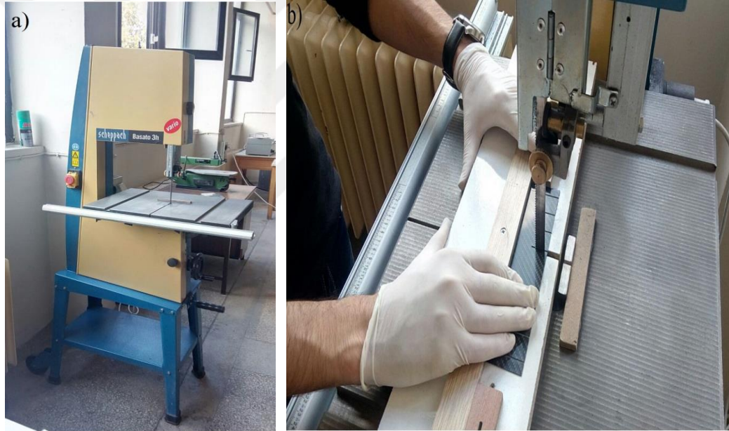
Şekil 6.5 a) Elektrikli şerit testere b) kanal açma işlemi.
