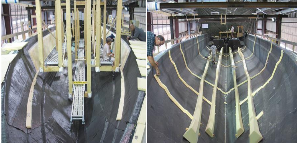
Şekil 3.2 Üretim aşamasındaki kompozit bir tekne [46].
