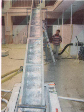
Şekil 6.9 Eşik yüksekliği 4 cm dan başlayıp 1 cm'ye kadar azalan trapez kesitli eşikler basamak kenarlarına 4 cm olan tarafı iki sağa, bir boş basamak ve iki basamak sola gelecek şekilde şaşırtmalı olan basamaklı dolusavak.
