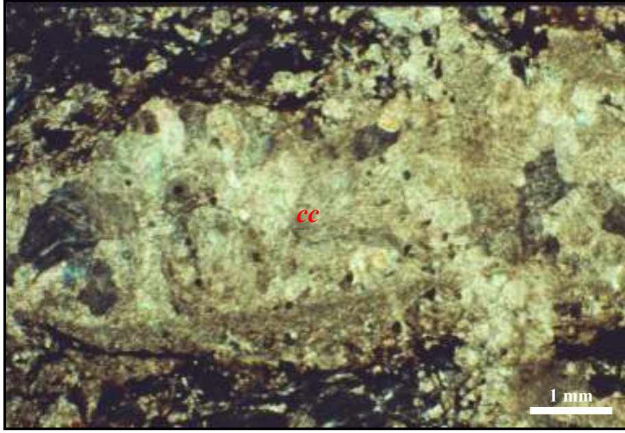
Şekil 5.5. Alterasyonun fazla olduğu serpentinitlerde gözlenen yoğun karbonatlaşma, kalsit (cc) (ÇNx32)
