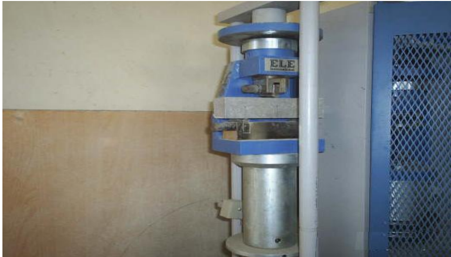
Şekil 2.17. Eğilmede Çekme Deneyi ve Deney Presi
