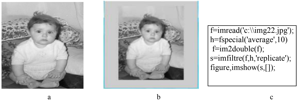
Şekil 7.5. (a) 'img22.jpg' görüntüsünün orijinal hali (b) (a) görüntüsüne 10 maske boyutlu ortalama alıcı (average) filtre uygulanmış hali (c) (b) için matlab komutları
