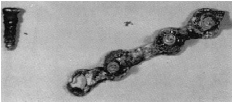
Şekil 1. Korozyondan dolayı kullanımdan kaldırılan Lane'in plağı (1895 ) (1).
