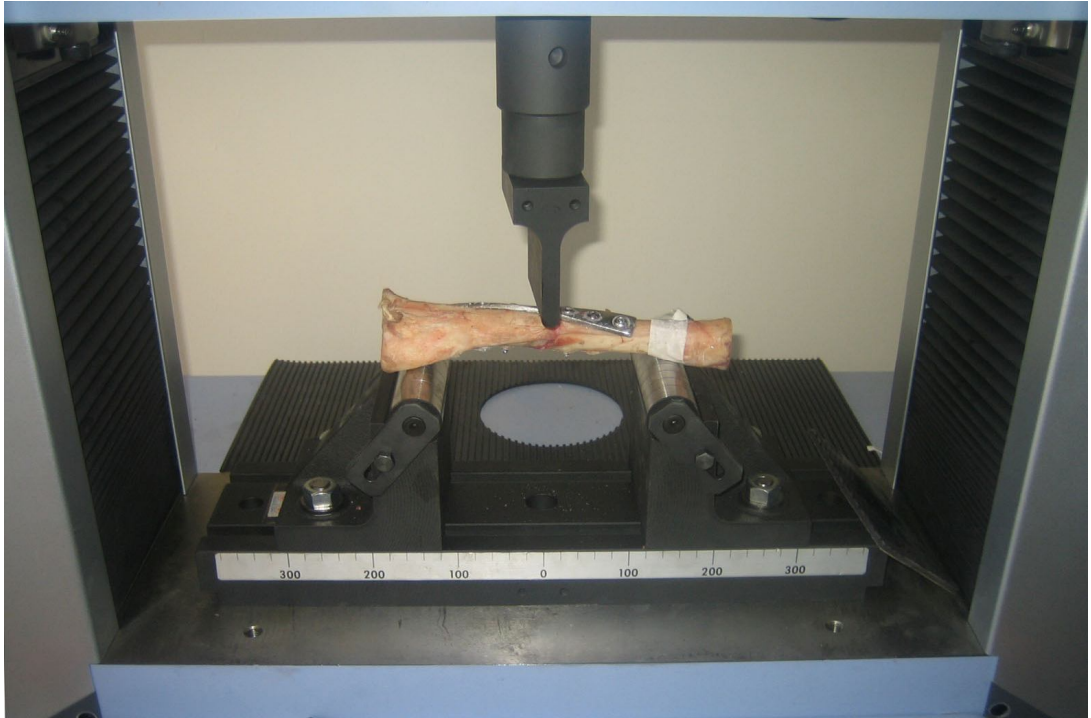
Şekil 24. Helikal plak tespiti uygulanan bir örneğin üç nokta eğme testi.
