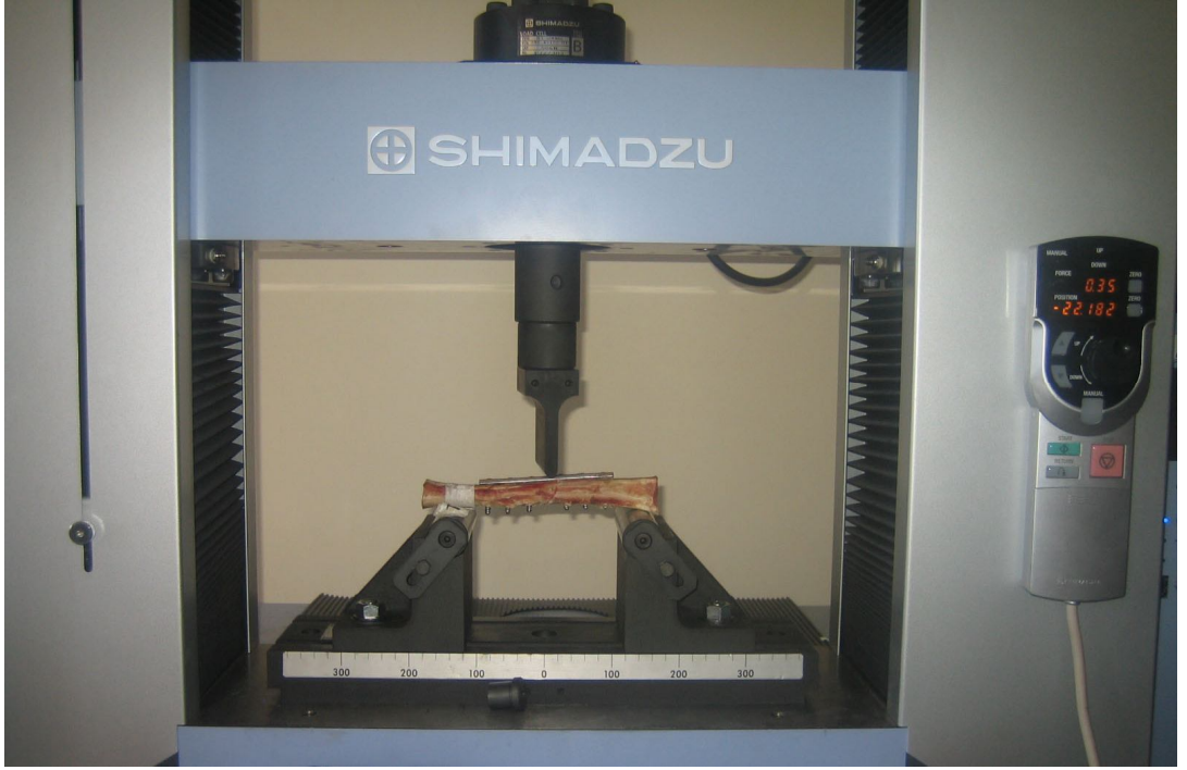
Şekil 23. Düz plak tespiti uygulanan bir örneğin üç nokta eğme testi.
