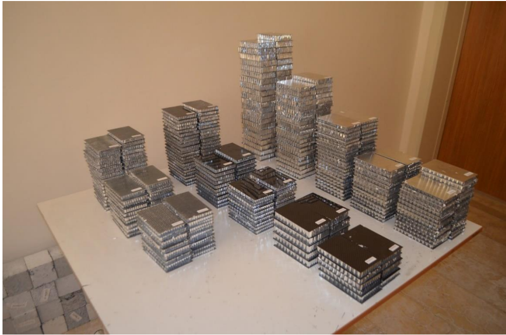
Şekil 5.4. Üretilen Bal Peteği Sandviç Kompozit Numuneler
