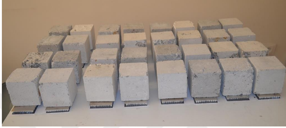
Şekil 5.3 Ağırlık Altında Bekletilen Sandviç Kompozitler
