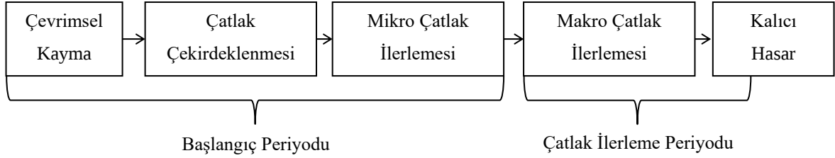
Şekil 3.1. Yorulma Çatlağının Evreleri
