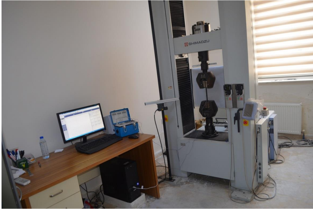
Şekil 5.5. Testler İçin Kullanılan Shimadzu Universal Test Cihazı
