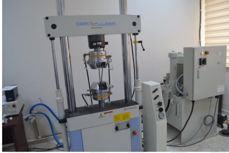
Şekil 5.12. Shimadzu Yorulma Test Cihazı
