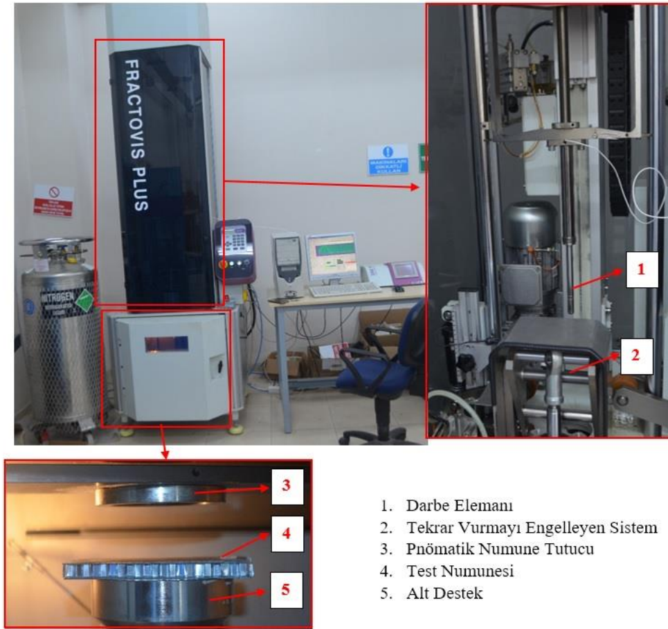
Şekil 5.11 Darbe Testleri İçin Kullanılan CEAST-Fractovis Plus Darbe Test Cihazı
