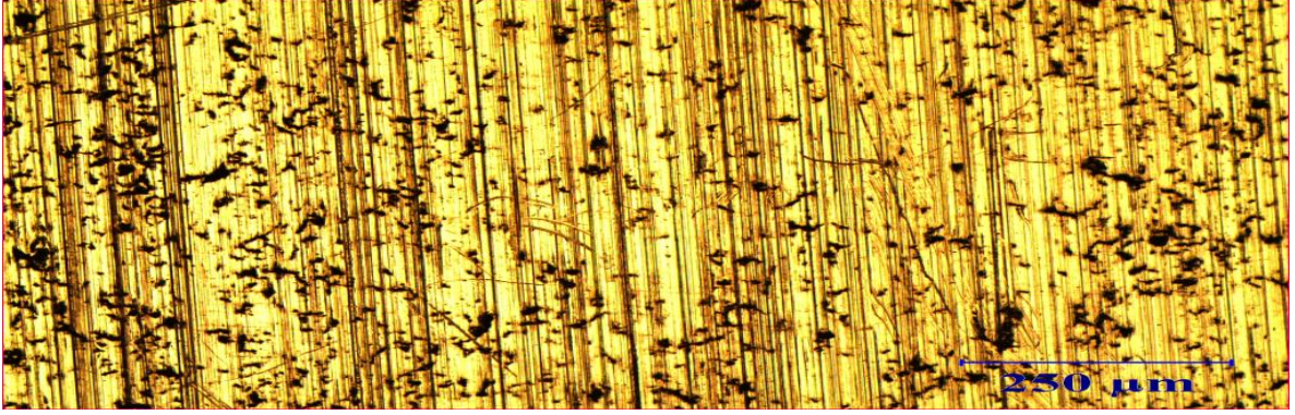
Şekil 5.13. Altıncı numunenin işlenmiş yüzeyinin 100x oranında büyütme görüntüsü
