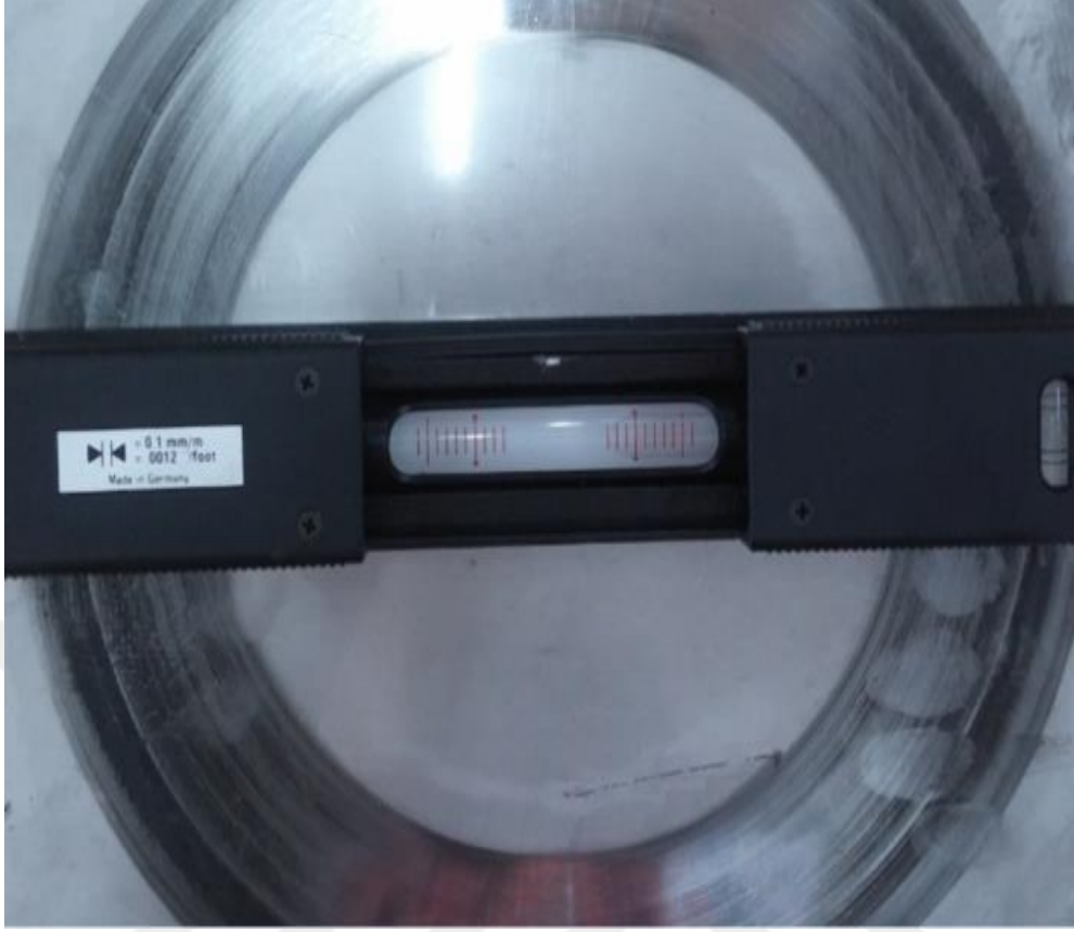
Şekil 4.3. Su terazisi ile paralellik ölçümü
