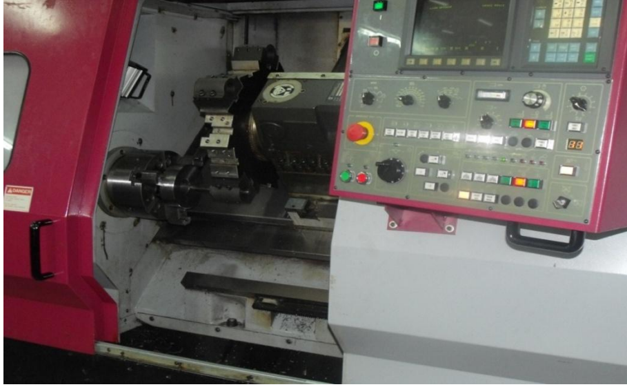
Şekil 4.3. Kalıp imalatı yapılan Fanuc O-T CNC torna tezgahı
