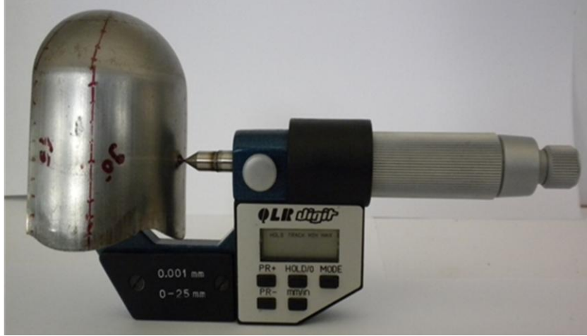
Şekil 5.28. Et kalınlığının ölçülmesi
