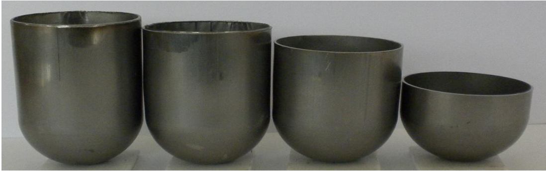
Şekil 5.34. Farklı ilkel parça çaplarında çekilen numunelerin kulaklanmış kısımlarının traşlandıktan sonraki görünümü
