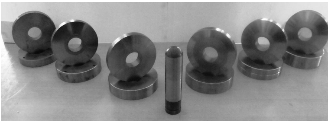
Şekil 4.2. Fanuc O-T CNC torna tezgahında imal edilen Matris/baskı plakası ve zimba
