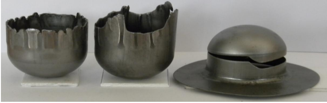
Şekil 5.33. Farklı ilkel parça çaplarında çekilen numunelerde meydana gelen değişik yırtılma ve çatlak hasarları
