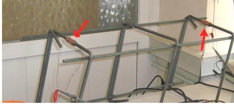
Resim 4.6. Kolon Donatısı Üzerine Sarılmış Bobinler
