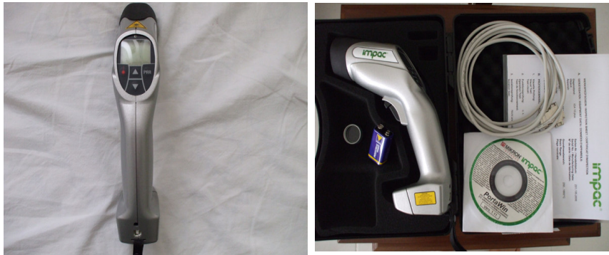
Şekil 6.9. Yüzey sıcaklık ölçümlerinin alındığı lazer pirometre
