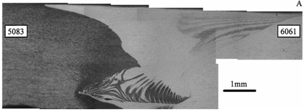
Şekil 4.4. AA 5083/AA6061 çiftinin kaynak sonrası mikroyapı görünümü (Shigematsu ve diğ., 2003)
