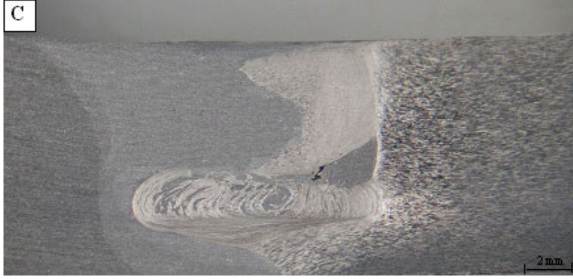
Şekil 7. 4. 900 dev/dak dönme hızında üçgen karıştırıcı uç ile birleştirilen numunelere ait makro görüntüler (a: 250 mm/dak, b: 200 mm/dak, c: 160 mm/dak)
