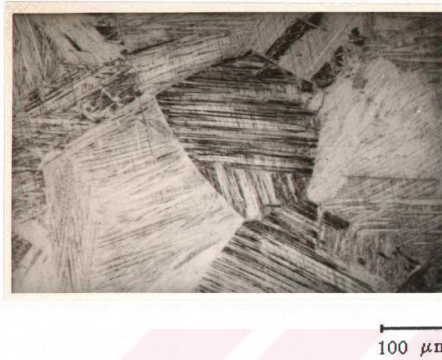
Şekil 6.35. Oda sıcaklığında 150 saat yaşlandırılan Alaşım 1 numunesinin genel tane yapısı.
