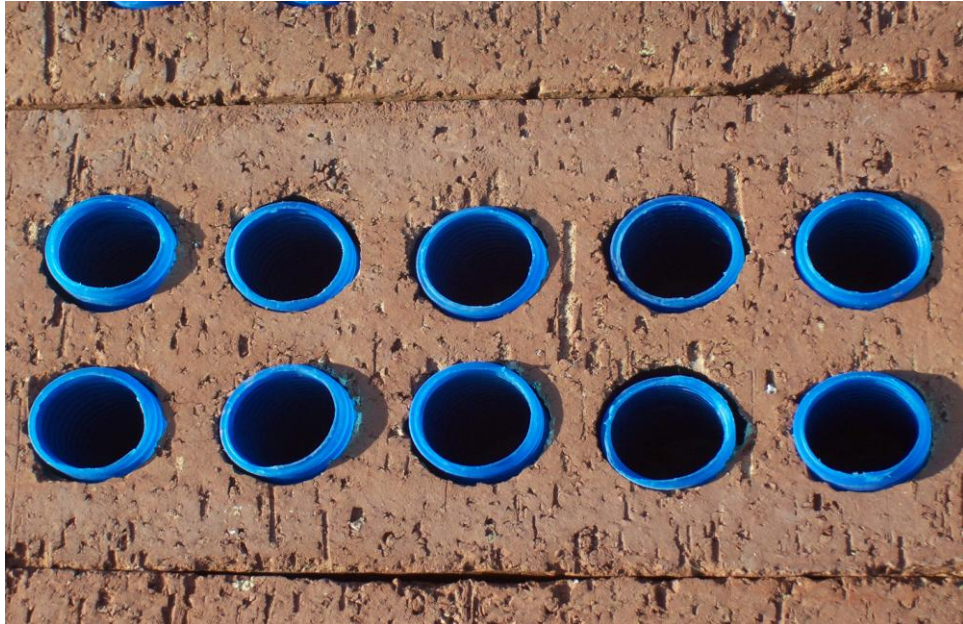
řekil 2.2. Faz deęiřtiren maddenin (FDM) doldurulacaęı silindirik kapsller.
