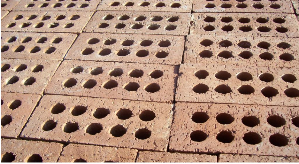
Şekil 2.3. Silindirik FDM kapsüllerinin yerleştirileceği delikli tuğlalar.
