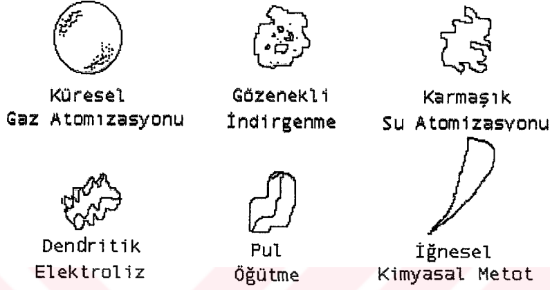
Şekil: 4. 2. Üretim yöntemlerine göre toz şekilleri
