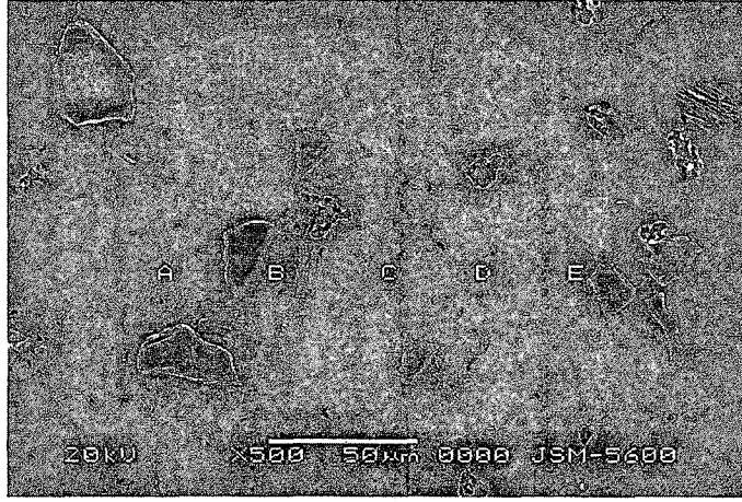
Şekil:7.37 600 °C-40 dak. difüzyon kaynağı yapılmış % 5-5 SiC Komp. Malzemenin SEM Analizi
