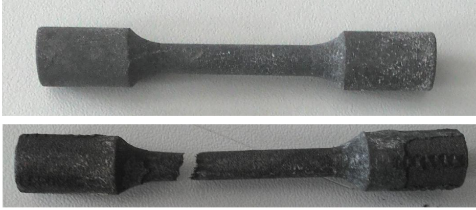
Şekil 6.9 Çekme işlemine tabi tutulan deney numunesi
