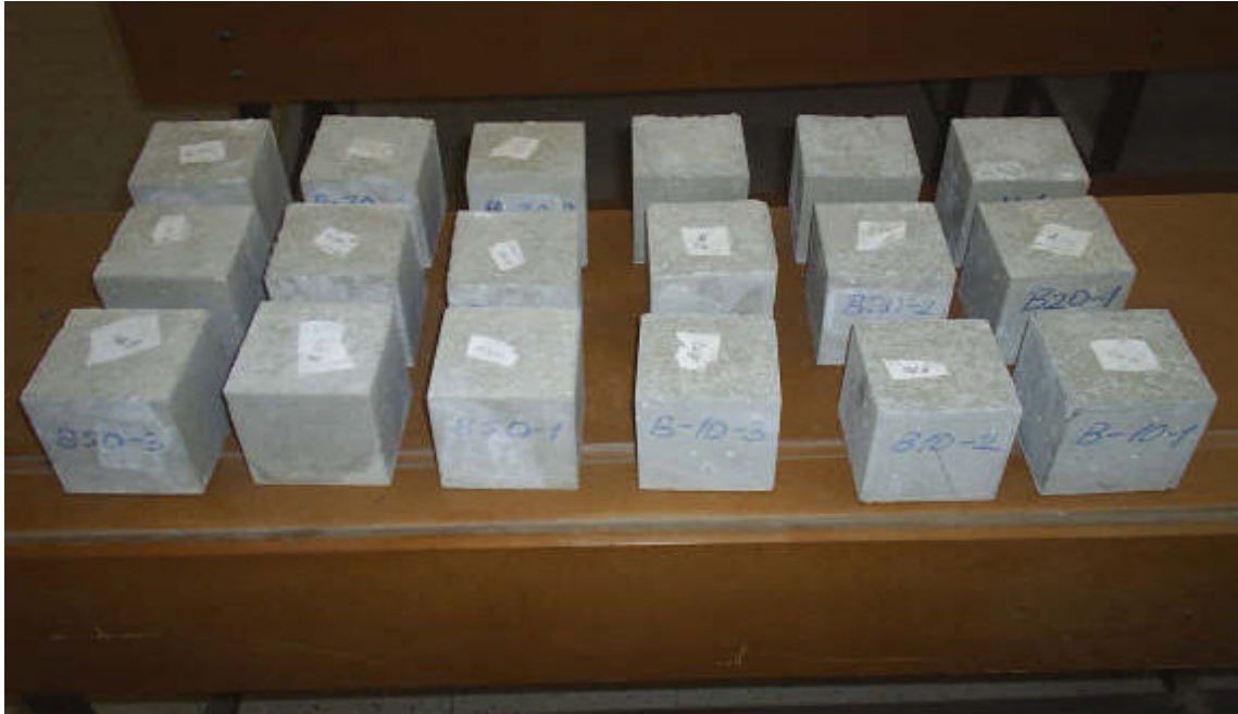
Şekil 3.1. Deneylerde Kullanılan Küp Numuneler
