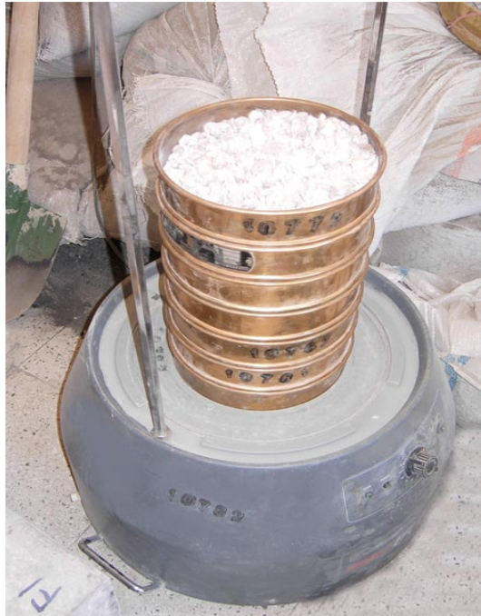
Şekil 3.5. Agregaların Elek Analizine Tabi Tutulması
