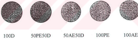
Şekil 5. 51. 250 bar enjeksiyon basıncı ve 3100 d/d'daki is oluşumu.
