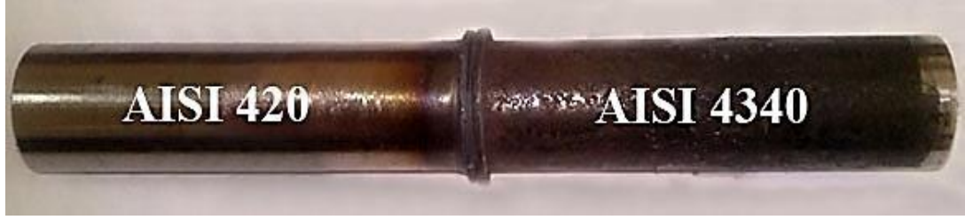
Şekil 4.4. Metalografik incelemeler öncesi C grubu numunesi
