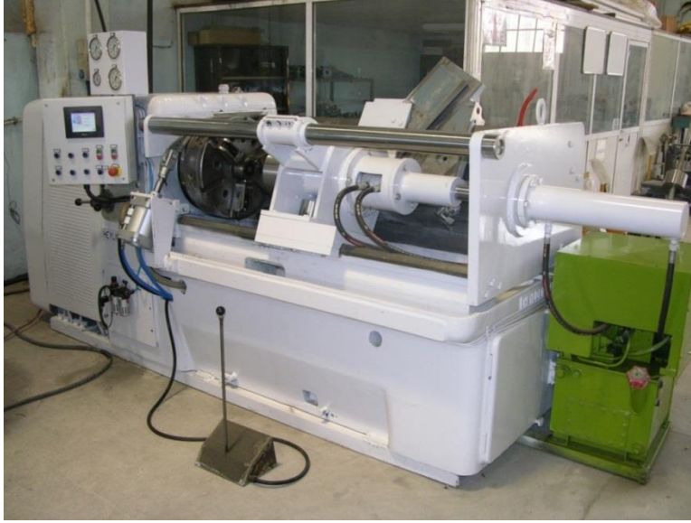
Şekil 4.2. PLC kontrollü sürtünme kaynak makinesi
