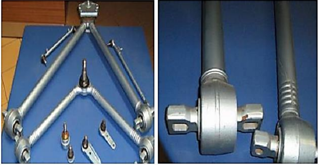
Şekil 3.31. Ticari araçlarda kullanılan, sürtünme kaynağı ve sıcak presleme uygulanmış “V” çeki kolları [31].
