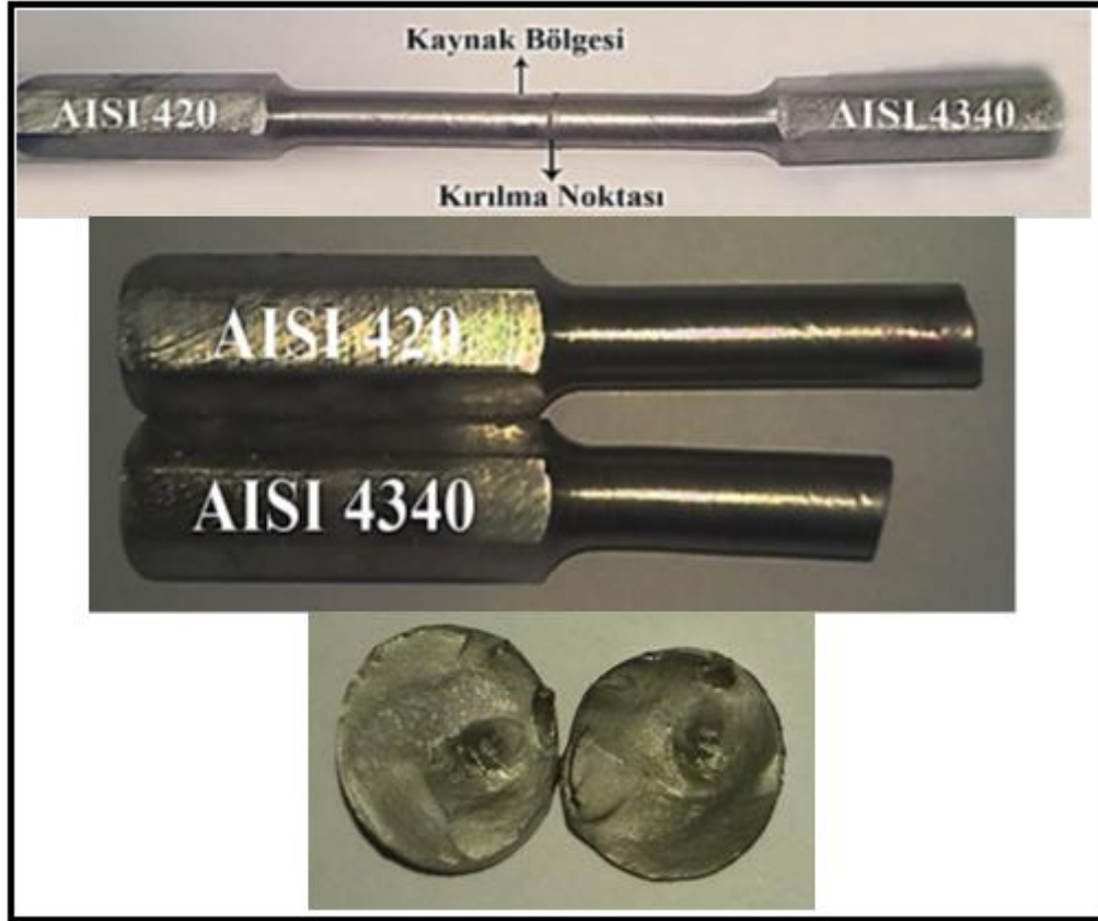
Şekil 5.116. C1 no'lu numuneye ait burulma deneyi sonunda elde edilen kırık yüzey makro fotoğrafları
