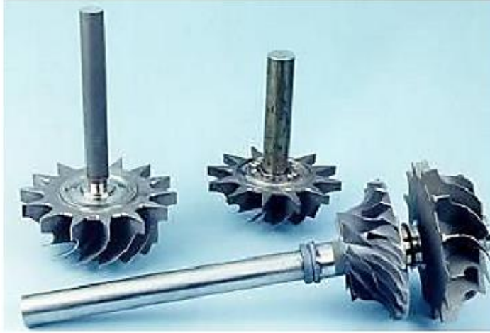
Şekil 3.33. Sürtünme Kaynağı ile imal edilmiş uçak parçası [31].
