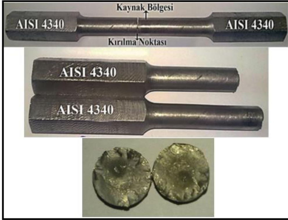
Şekil 5.113. B3 no'lu numuneye ait burulma deneyi sonunda elde edilen kırık yüzey makro fotoğrafları
