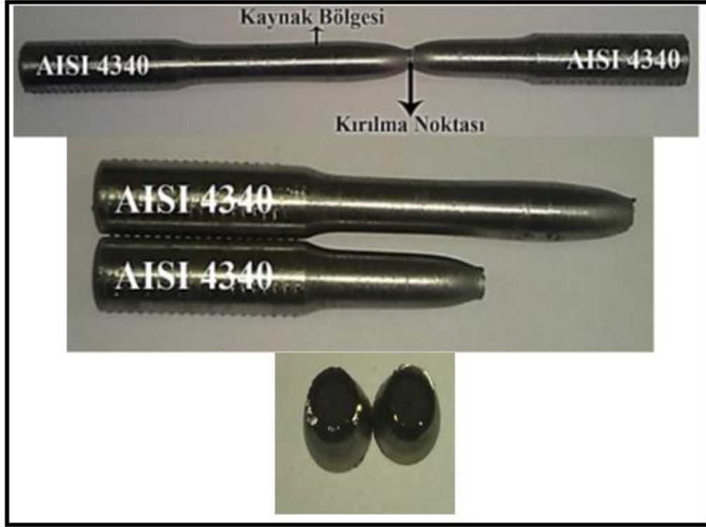
Şekil 5.81. B2 no'lu numunelere ait çekme deneyi sonunda elde edilen kırık yüzey makro fotoğrafları
