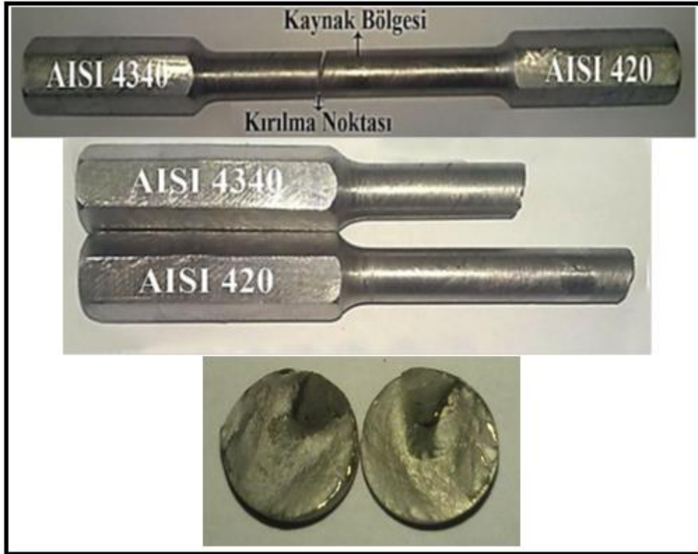
Şekil 5.119. C2 no'lu numuneye ait burulma deneyi sonunda elde edilen kırık yüzey makro fotoğrafları
