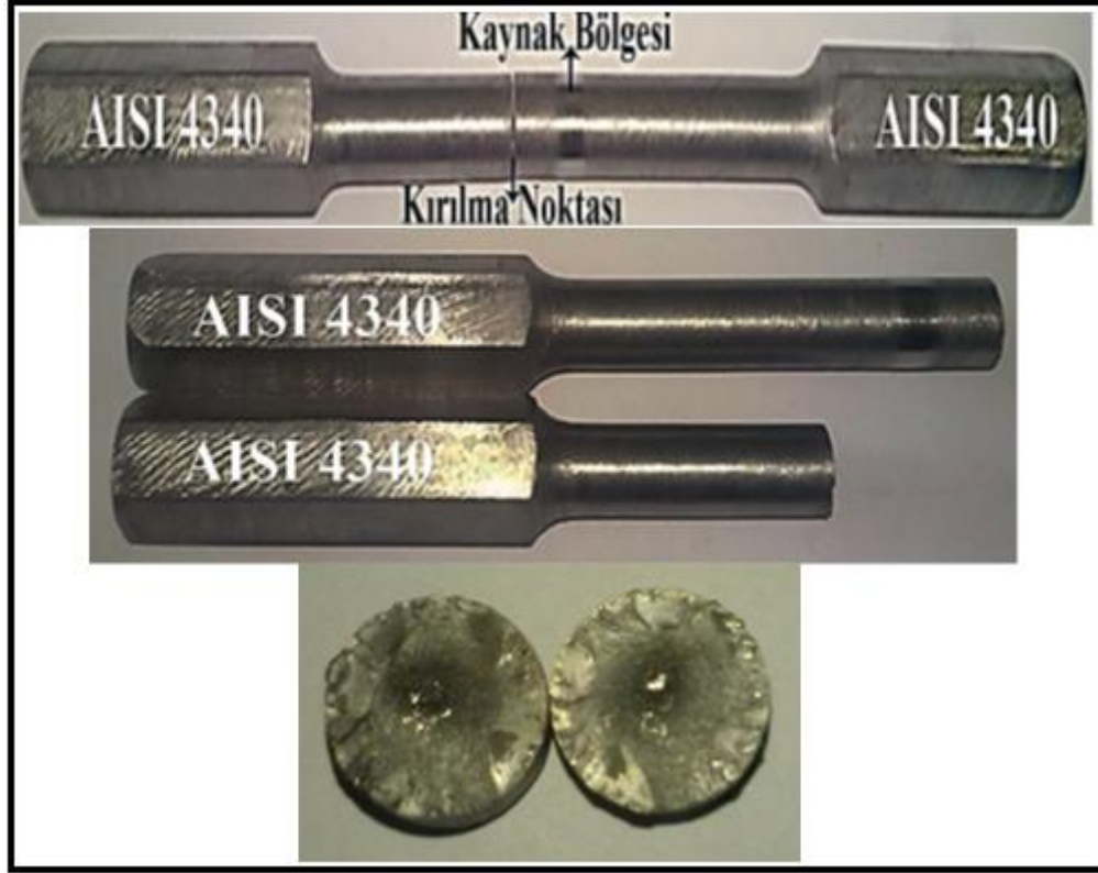
Şekil 5.107. B1 no'lu numuneye ait burulma deneyi sonunda elde edilen kırık yüzey makro fotoğrafları
