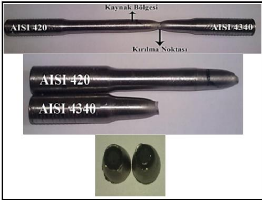
Şekil 5.93. C3 no'lu numuneye ait çekme deneyi sonunda elde edilen kırık yüzey makro fotoğrafları
