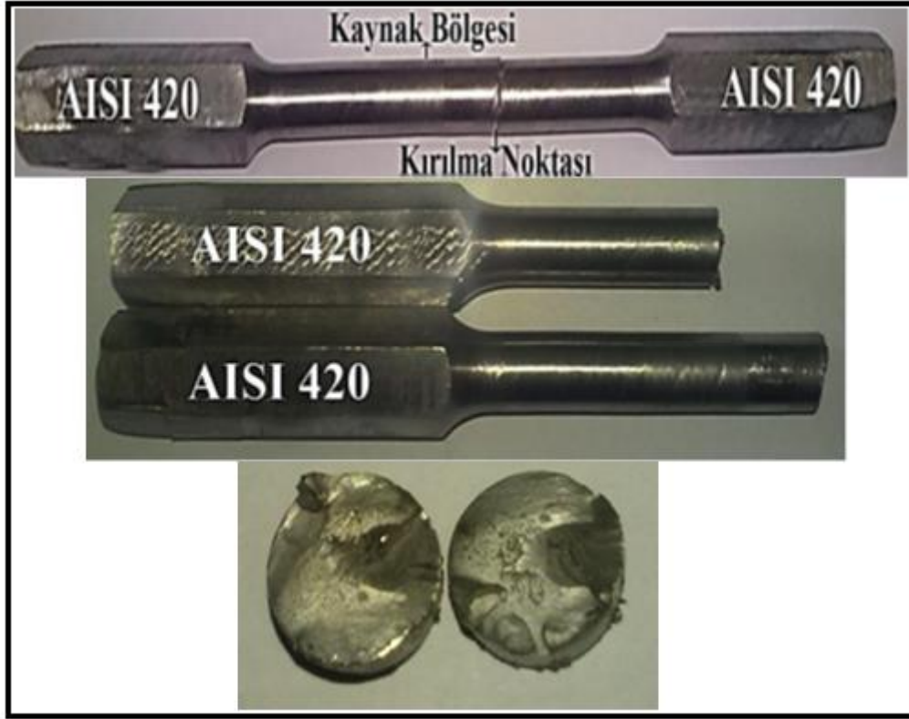
Şekil 5.104. A3 no'lu numuneye ait burulma deneyi sonunda elde edilen kırık yüzey makro fotoğrafları
