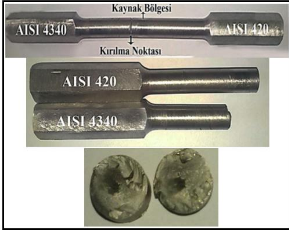
Şekil 5.122. C3 no'lu numuneye ait burulma deneyi sonunda elde edilen kırık yüzey makro fotoğrafları
