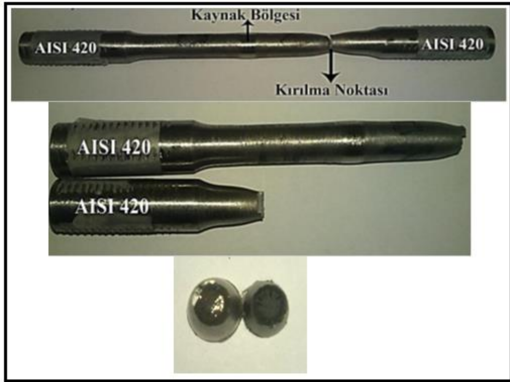
Şekil 5.72. A2 no'lu numuneye ait çekme deneyi sonunda elde edilen kırık yüzey makro fotoğrafları
