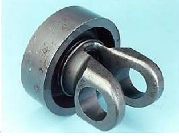
Şekil 3.29. Sürtünme kaynağı ile imal edilmiş dizel motor pistonu [31,44].
