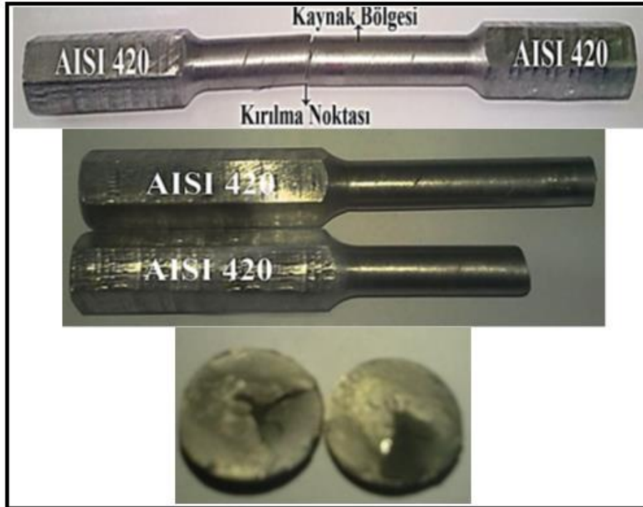
Şekil 5.101. A2 no'lu numuneye ait burulma deneyi sonunda elde edilen kırık yüzey makro fotoğrafları
