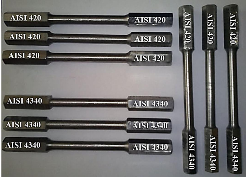
Şekil 4.13. A, B ve C gruplarına ait burulma deney numuneleri
