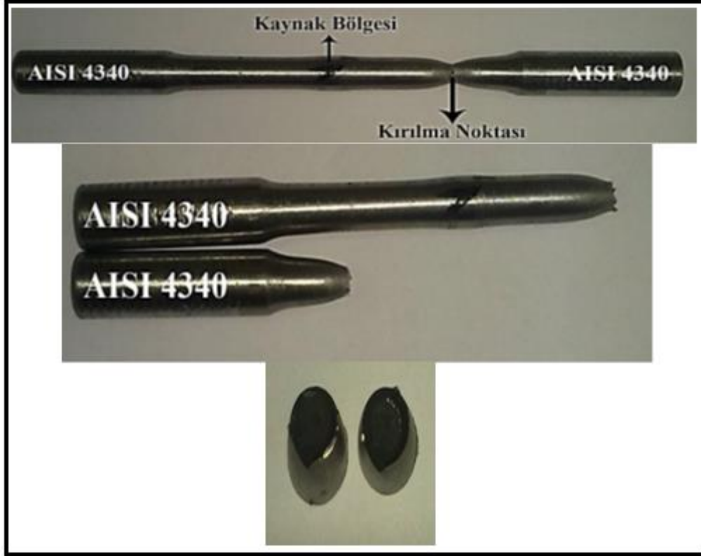
Şekil 5.78. B1 no'lu numunelere ait çekme deneyi sonunda elde edilen kırık yüzey makro fotoğrafları
