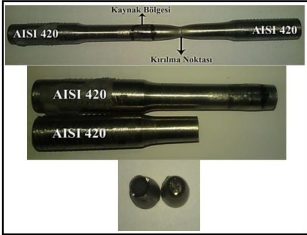
Şekil 5.75. A3 no'lu numunelere ait çekme deneyi sonunda elde edilen kırık yüzey makro fotoğrafları
