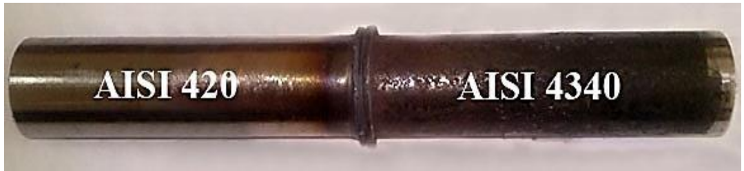
Şekil 5.3. C1 no’lu numuneye ait yüzey fotoğrafı
