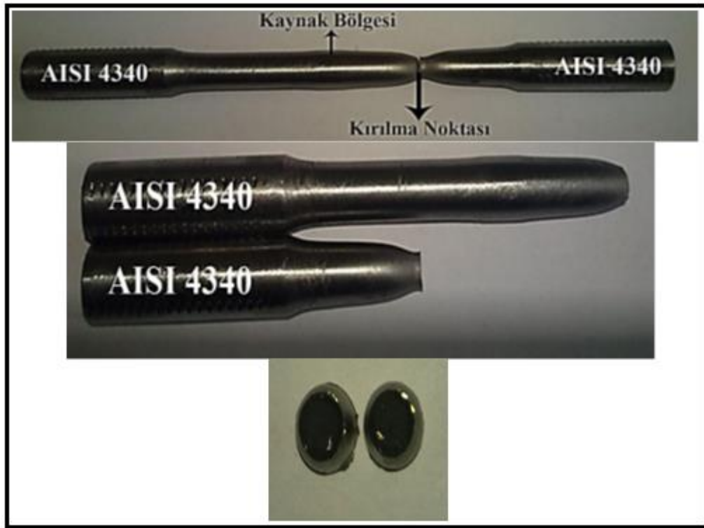
Şekil 5.84. B3 no'lu numuneye ait çekme deneyi sonunda elde edilen kırık yüzey makro fotoğrafları
