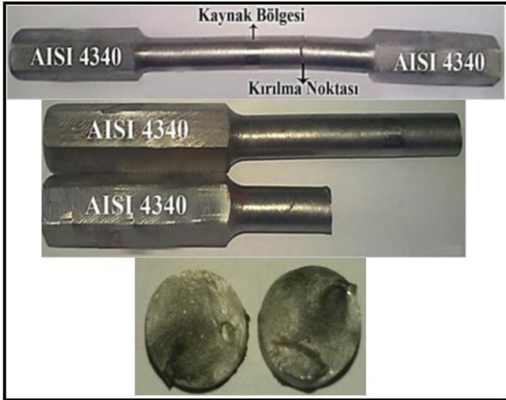
Şekil 5.110. B2 no'lu numuneye ait burulma deneyi sonunda elde edilen kırık yüzey makro fotoğrafları
