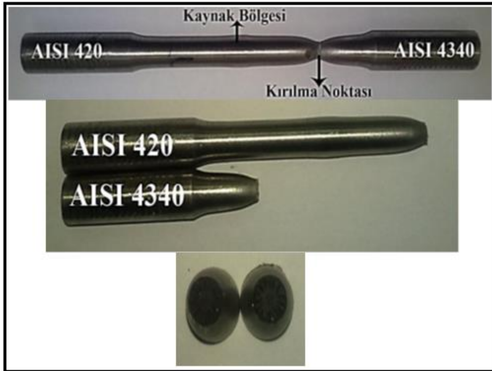
Şekil 5.87. C1 no'lu numunelere ait çekme deneyi sonunda elde edilen kırık yüzey makro fotoğrafları
