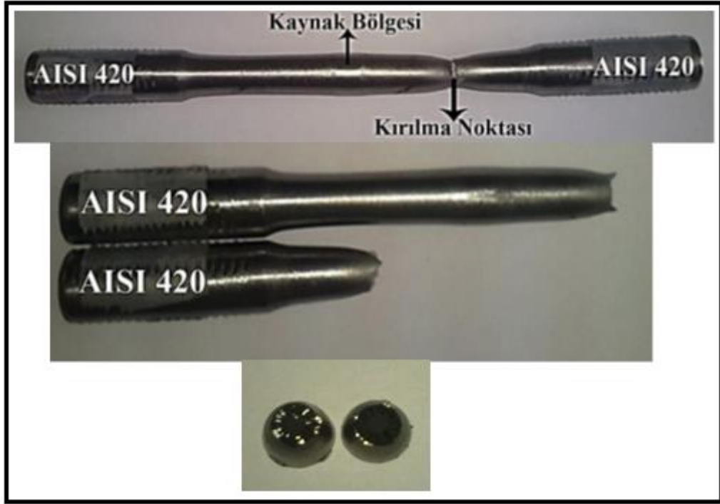
Şekil 5.69. A1 no'lu numuneye ait çekme deneyi sonunda elde edilen kırık yüzey makro fotoğrafları
