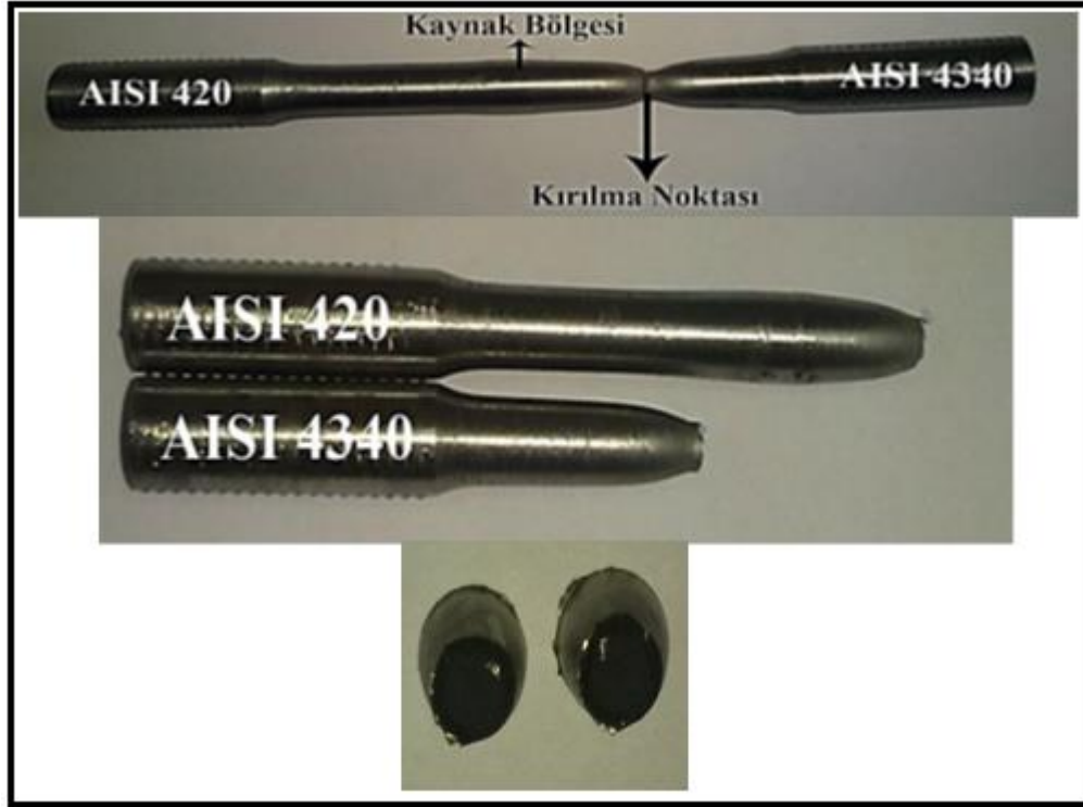
Şekil 5.90. C2 no'lu numuneye ait çekme deneyi sonunda elde edilen kırık yüzey makro fotoğrafları
