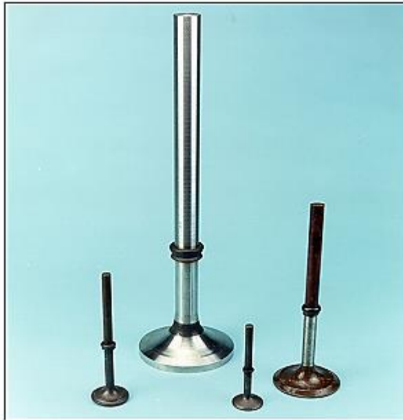
Şekil 3.30. Sürtünme kaynağı ile imal edilmiş egzoz supapları [31,44]
