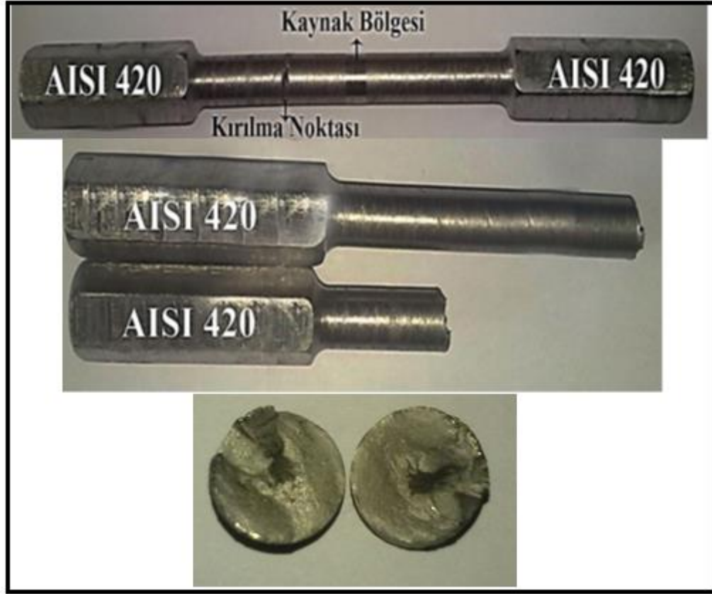
Şekil 5.98. A1 no'lu numuneye ait burulma deneyi sonunda elde edilen kırık yüzey makro fotoğrafları
