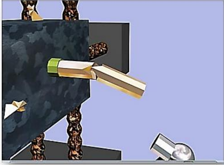
Şekil 3.46. Burulmaya maruz kalan bir numune [77].
