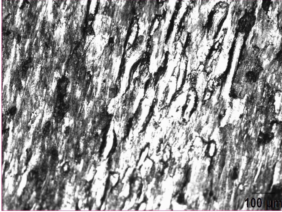
Şekil 3.15. N5numunesinin aşınma yüzeyinin 2500 m’lik kayma mesafesi sonundaki optik mikroskop resmi
