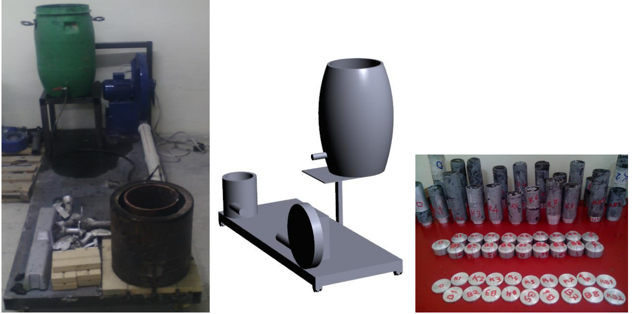
Şekil 2.1. Döküm makinesi basit bir tasarımı ve numuneler
