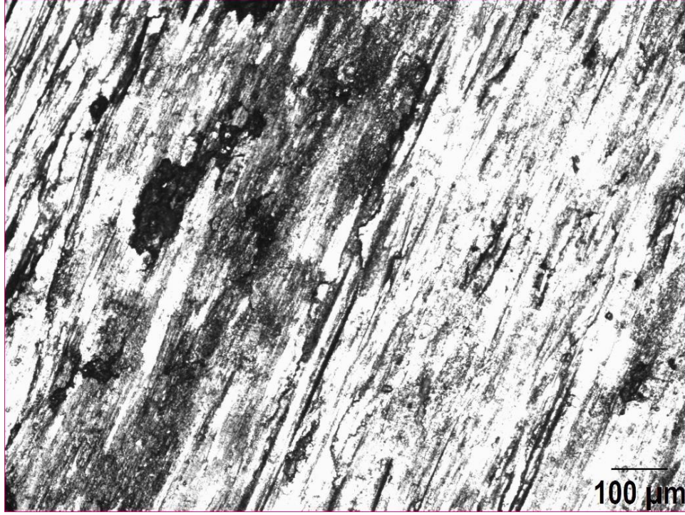
Şekil 3.5. NR numunesinin aşınma yüzeyinin 2500 m’lik kayma mesafesi sonundaki optik mikroskop resmi
