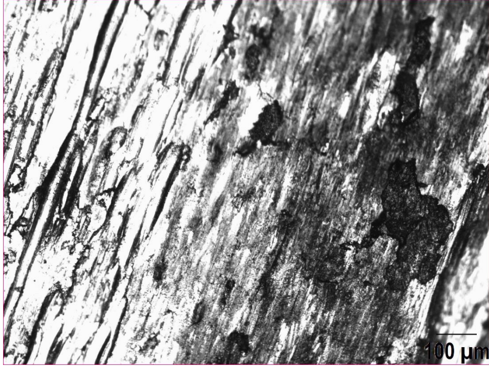
Şekil 3.13. N4numunesinin aşınma yüzeyinin 2500 m’lik kayma mesafesi sonundaki optik mikroskop resmi
