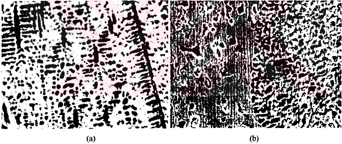
Şekil 7.41. II.grupta 3 nolu numunenin alaşımlandırılan katmanının optik (X400) ve geçiş bölgesinin SEM fotoğrafları [140 A, 9 gr (Fe, Mn)].
