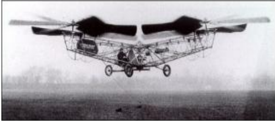
Şekil 3.4. Dr.George De Bothezat ve Ivan Jerome tarafından tasarlanan quadcopter
