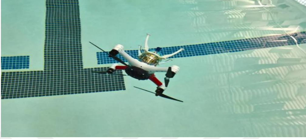
Şekil 3.9. Oookland Üniversitesi hem hava hem su altı ortamlarda çalışan LoonCopter
