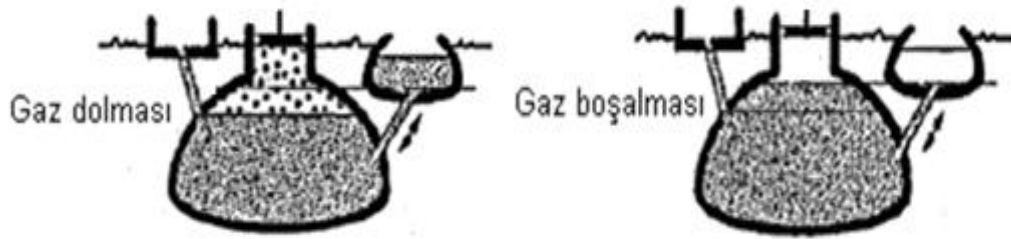
Şekil 1.44. Sabit kubbeli biyogaz reaktörü ve gaz basınçlandırma prensibi (Öztürk, 2005).
