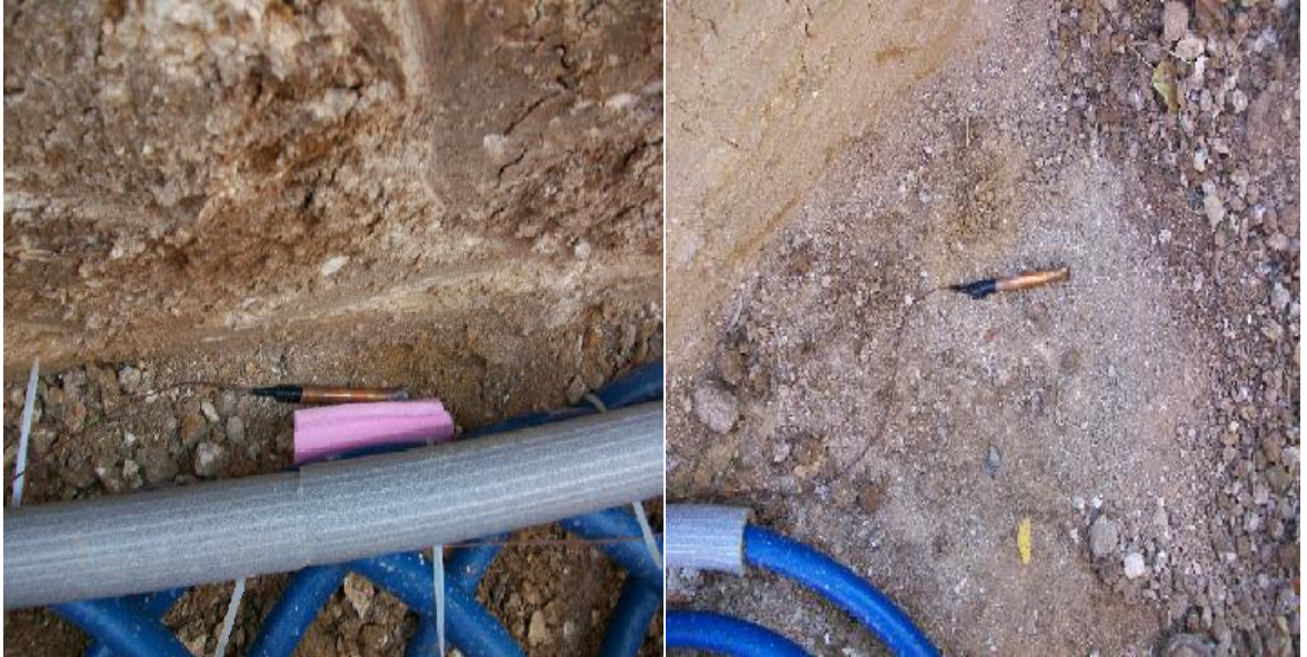
Şekil 2.3. Boru hizasına yerleştirilmiş olan ısıtıcı çiftler
