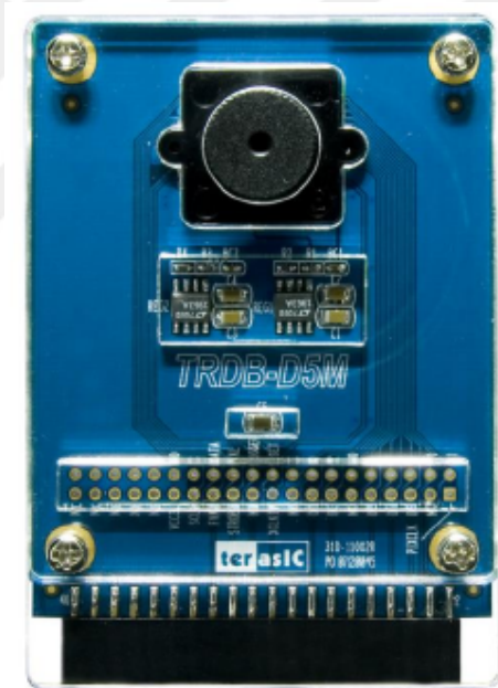
Şekil 4.6: Terasic TRDB-D5M 5 megapiksel kamera kartı
