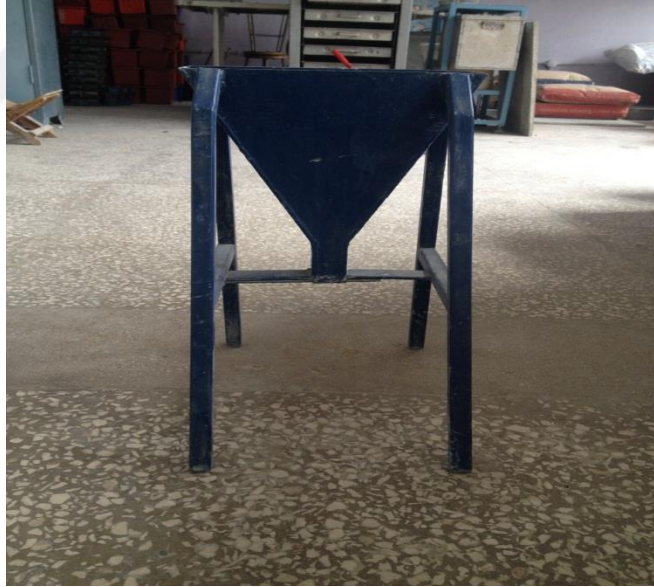
Şekil 2.4. Mini V hunisi deney düzeneği
