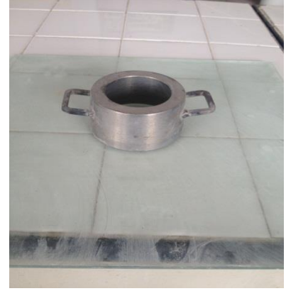
Şekil 2.2. Mini çökme-yayıllma deneyi düzeneği ve aparatı
