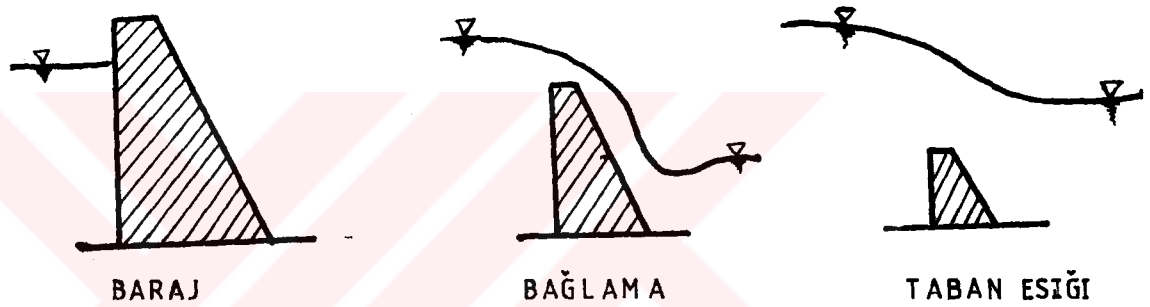
Şekil 5.1: Kabartma yapılarının memba ve mansab su seviyelerine göre değerlendirilmesi.
