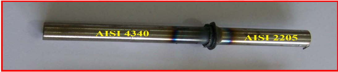
Şekil 8.1. Kaynak bölgesinde oluşan flanş ve IEB’ nin gösterimi.
