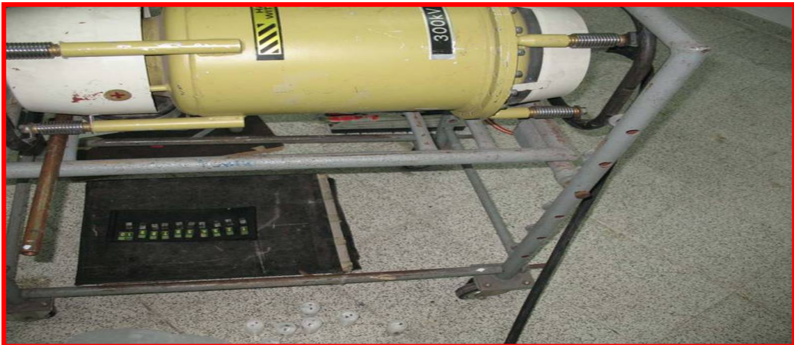
Şekil7.14.Film, penetrometer, şablonlu kalıp, ışın kümesi.[84].
