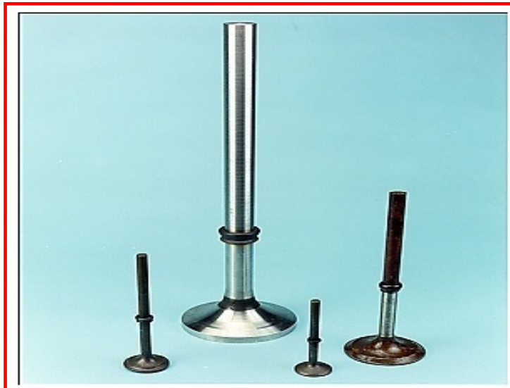
Şekil 5.17.Sürtünme kaynağı ile imal edilmiş egzoz supapları [71,80]
