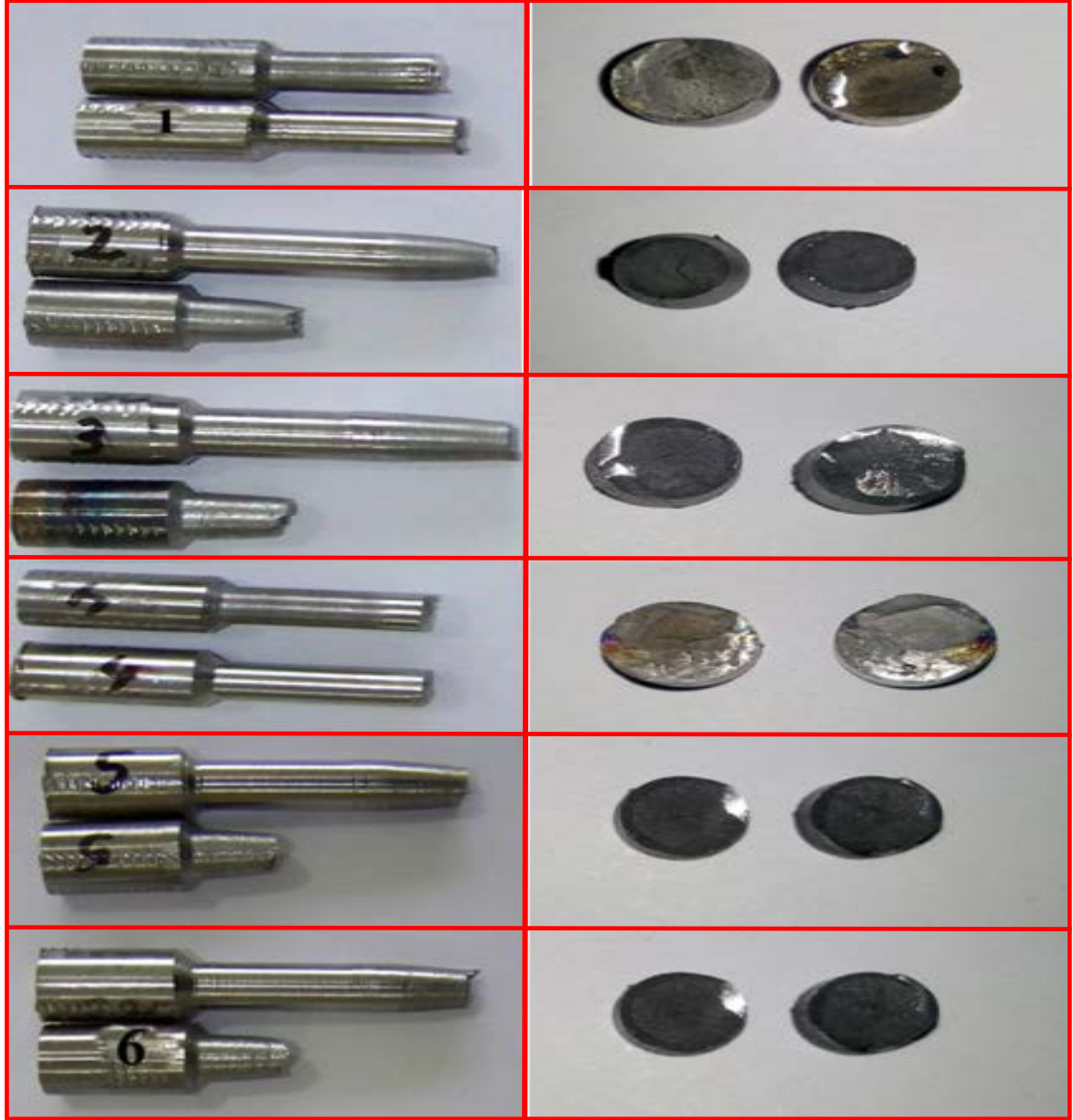
Şekil 8.21 .N1, N2, N3, N4, N5 ve N6 no'lu numunelerin çekme testi sonunda ki kırık yüzey makro fotoğrafları.
