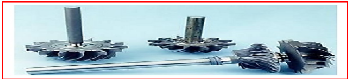
Şekil 5.20. Sürtünme Kaynağı ile imal edilmiş uçak parçası[71].
