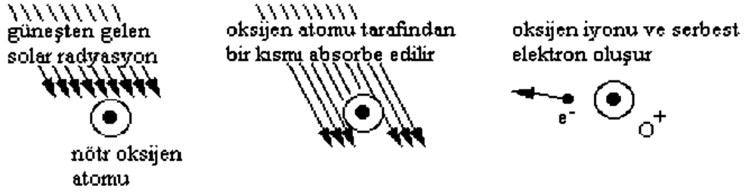
Şekil 2.9. Foto-iyonlaşma ile serbest elektron oluşumu [15]
