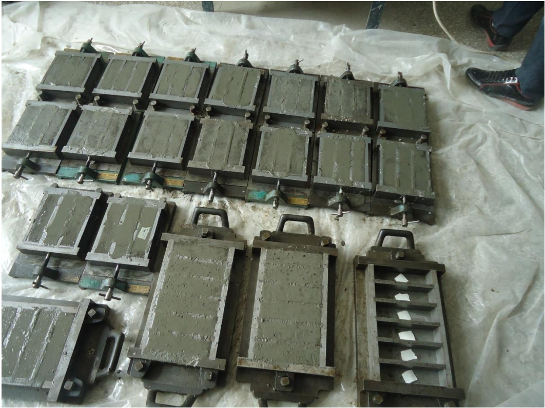
Şekil 3.2. 40 \times 40 \times 160 \text{ mm} ’lik prizmatik numuneler
