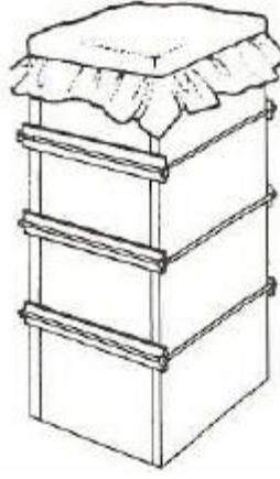
Şekil 2.5. Polietilen örtülerle kalıp koruması
