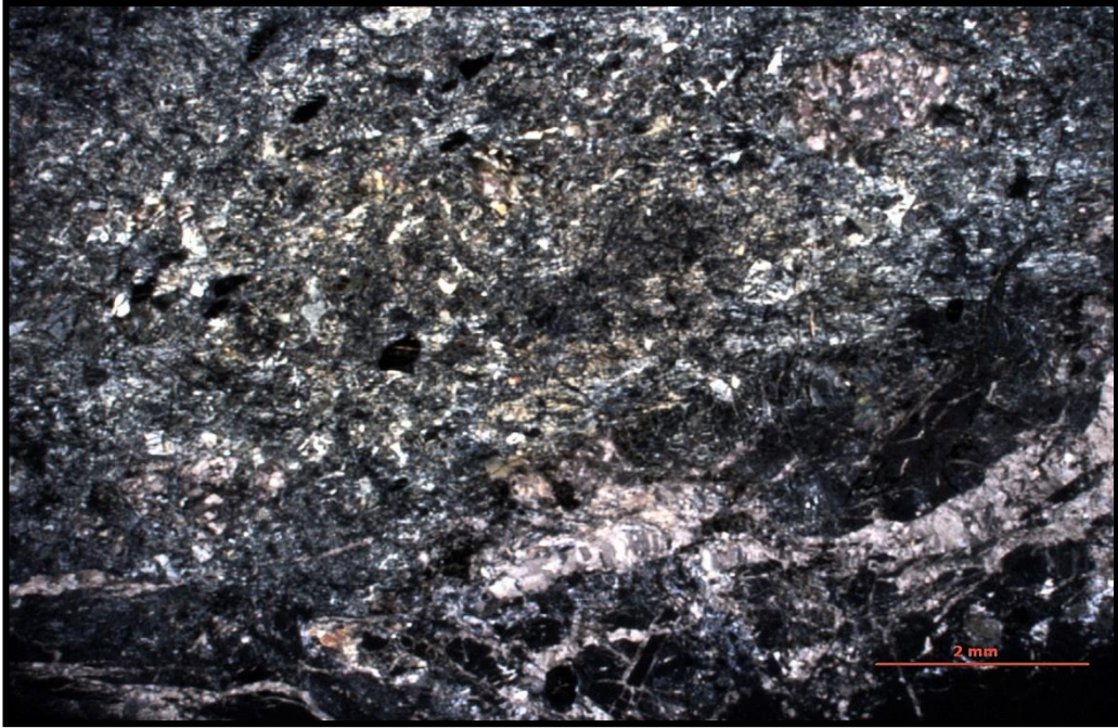
Şekil 3.29. “Kulp Vişne” örneğinin ince kesit görünümü (çift nikol)
