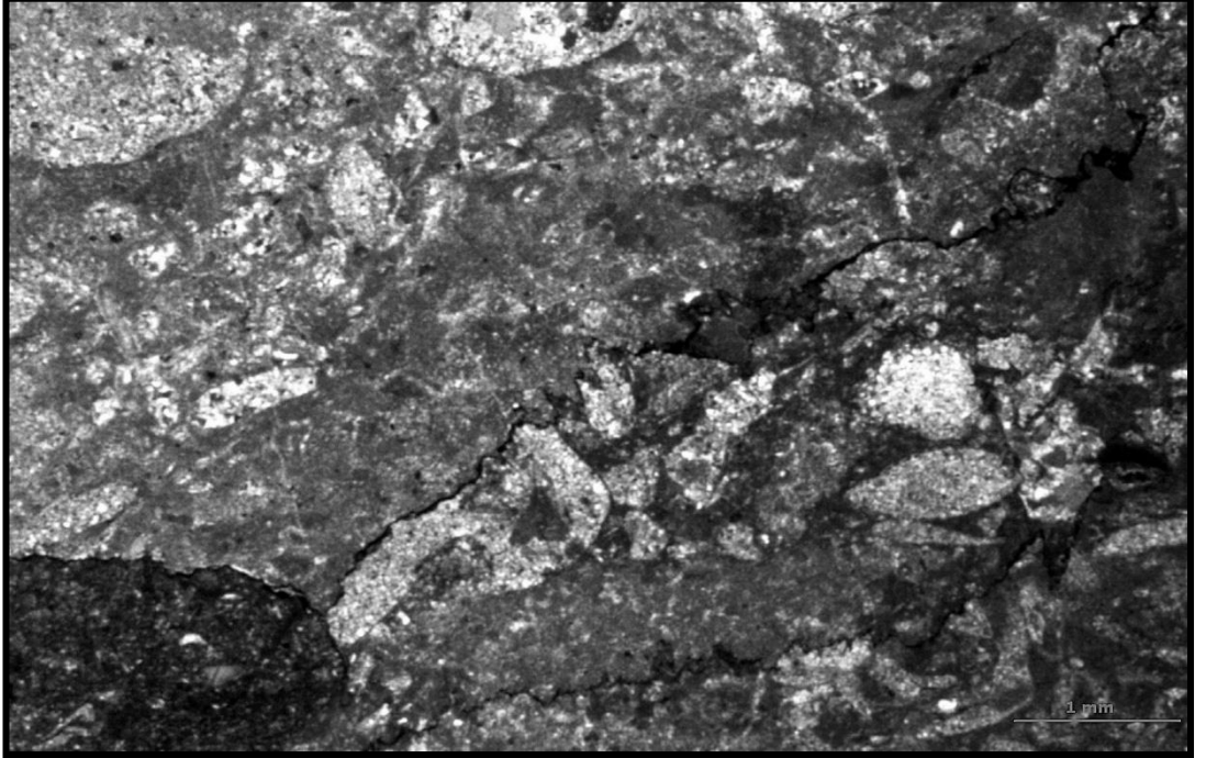
Şekil 3.22. “Chem Gray” örneğinin ince kesit görünümü (çift nikol)
