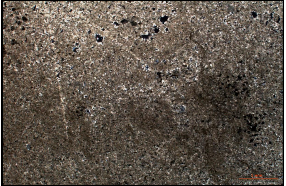
Şekil 3.26. “Crema Kulp” örneğinin ince kesit görünümü (çift nikol)
