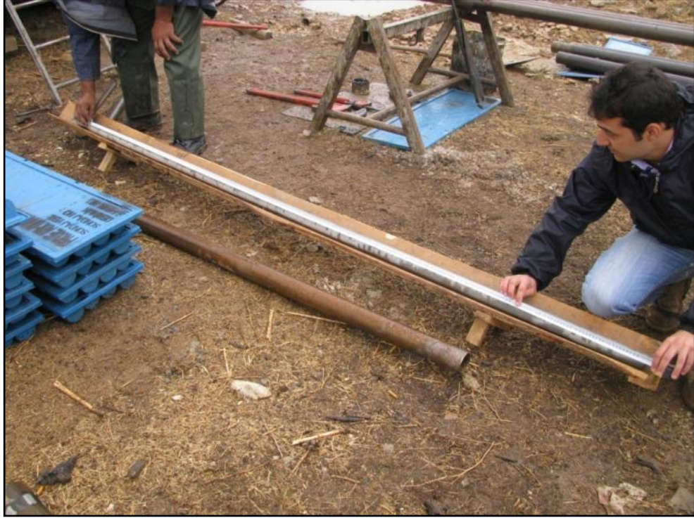
Şekil 3.9. Sondajda karot alımı
