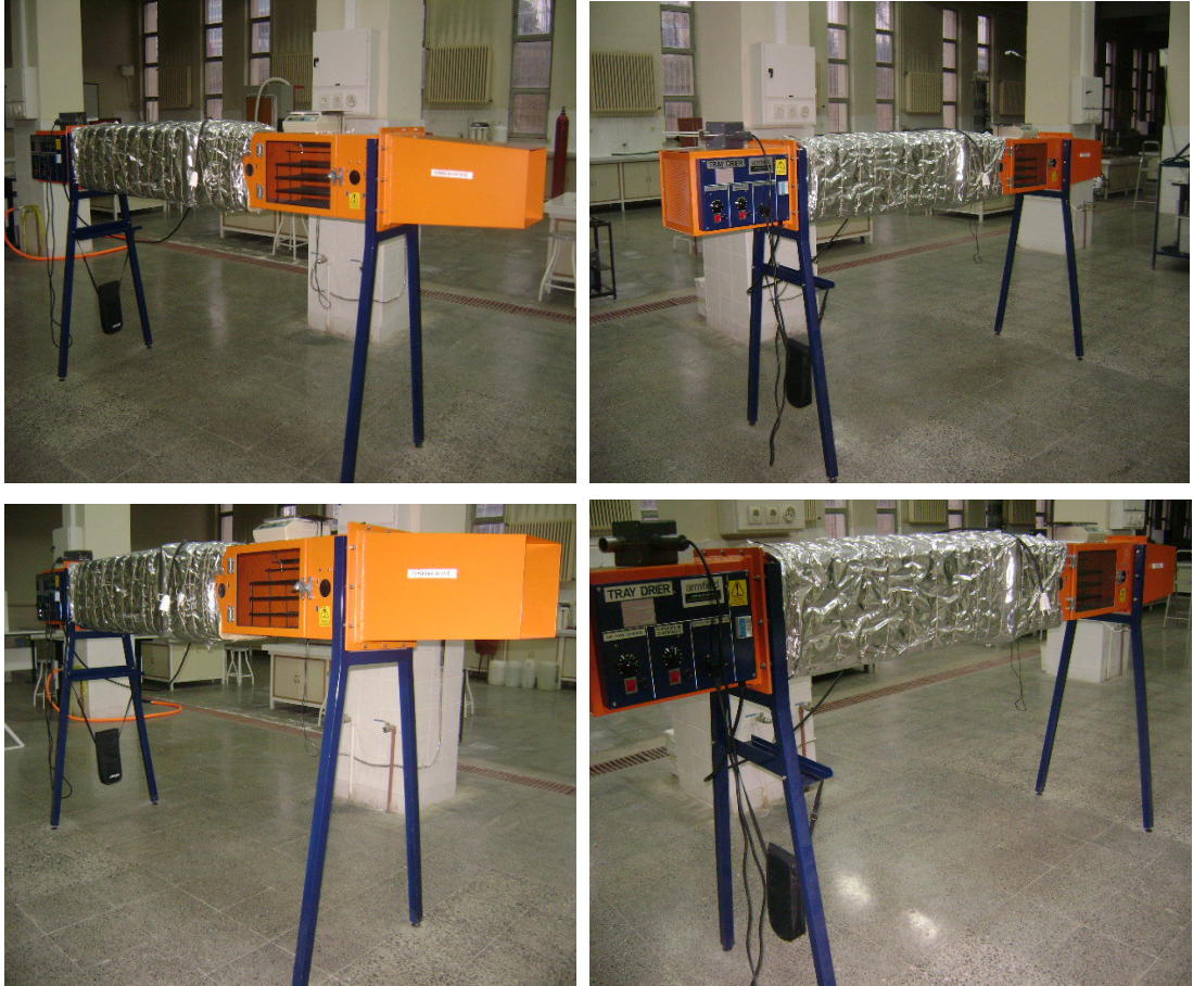
Şekil 5.2. Düz akışlı hava ile deneylerin yapıldığı tepsili kanal tip kurutucu
