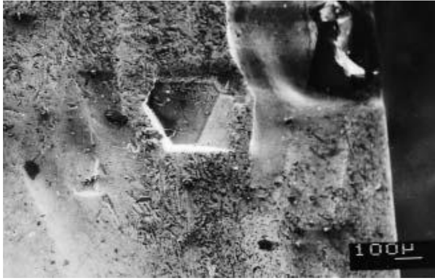
Şekil. 4.2. Kopan elmas tanesi çevresindeki aşınma bölgesi.
