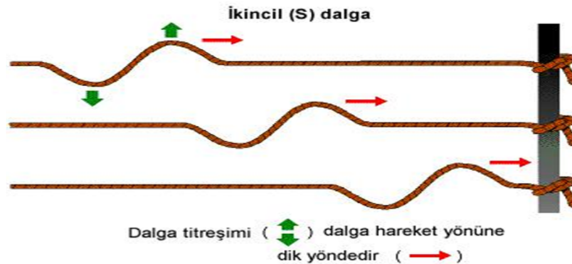
Şekil 1.3 Gerilmiş bir ip üzerinde ilerleyen enine dalga
