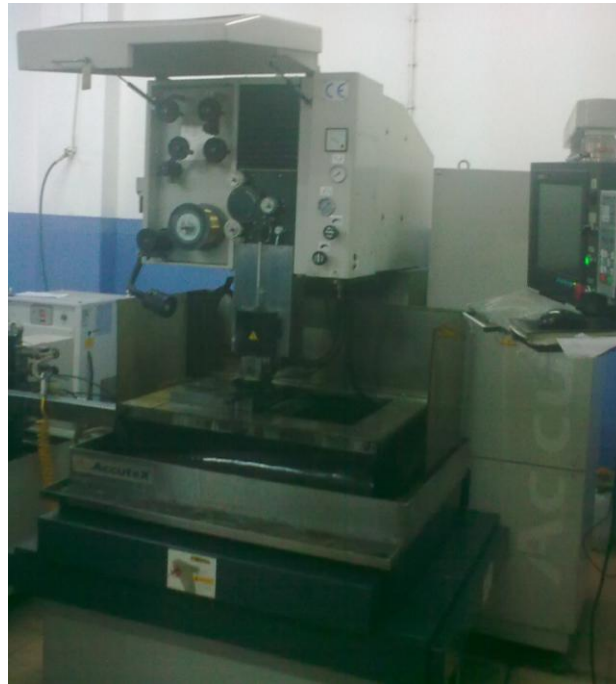
Şekil 5.4 Deneylerde kullanılan tel erozyon tezgahı
