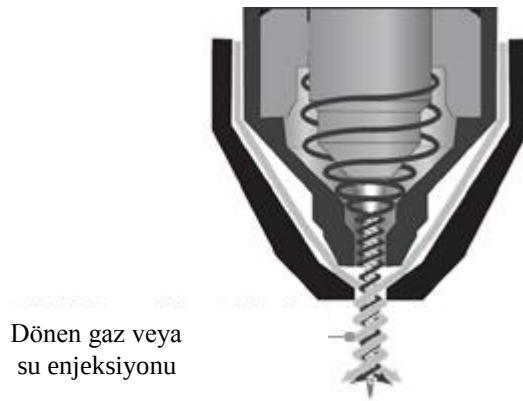
Şekil 4.17 Dönen gaz plazma kesim sisteminin şematik gösterimi [108].
