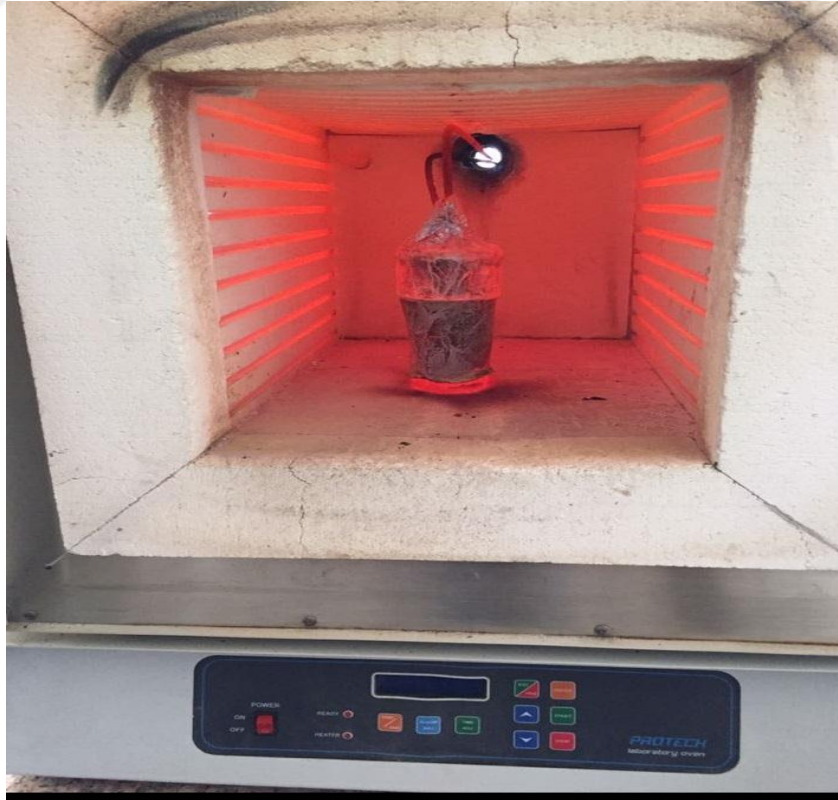
Şekil 3.1. Karbonizasyon deneylerinin yapıldığı reaktör ve fırın
