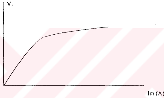
Şekil 3.12 Asenkron motorun boşa çalışma karakteristiği
