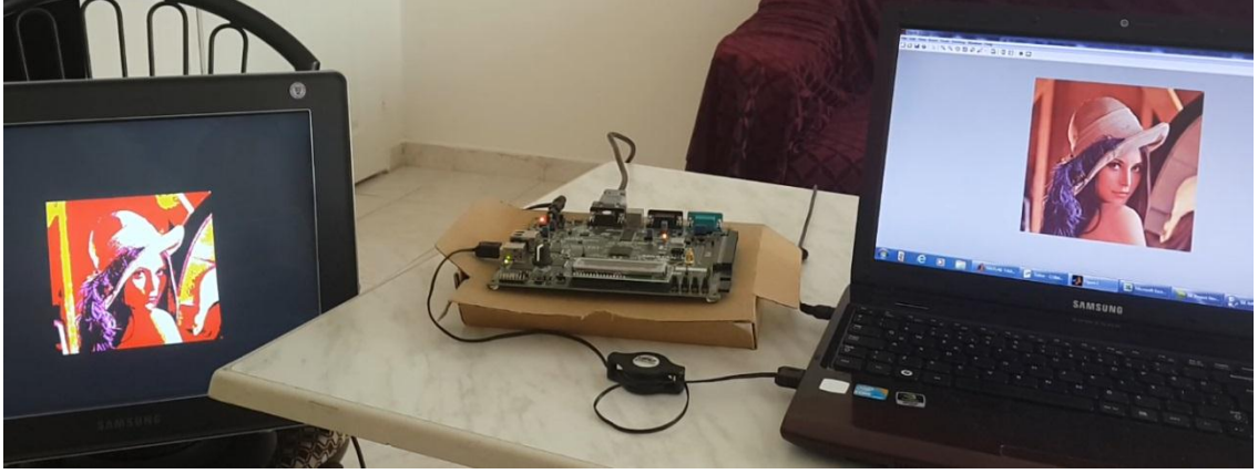
Şekil 7.25 'Lena' görüntüsünün FPGA üzerinden aktarılması
