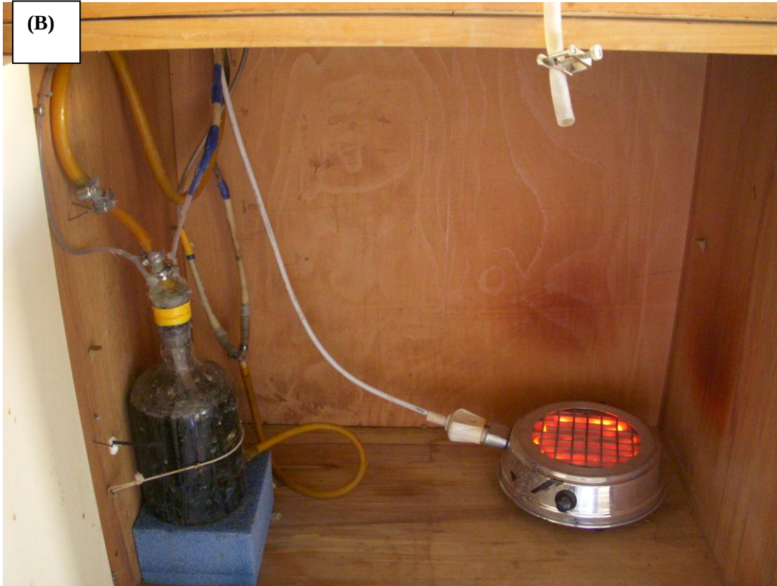
Şekil 5.2. Anaerobik Membran Biyoreaktörü. A) Genel Görünüm, B) Reaktör Hücresi
