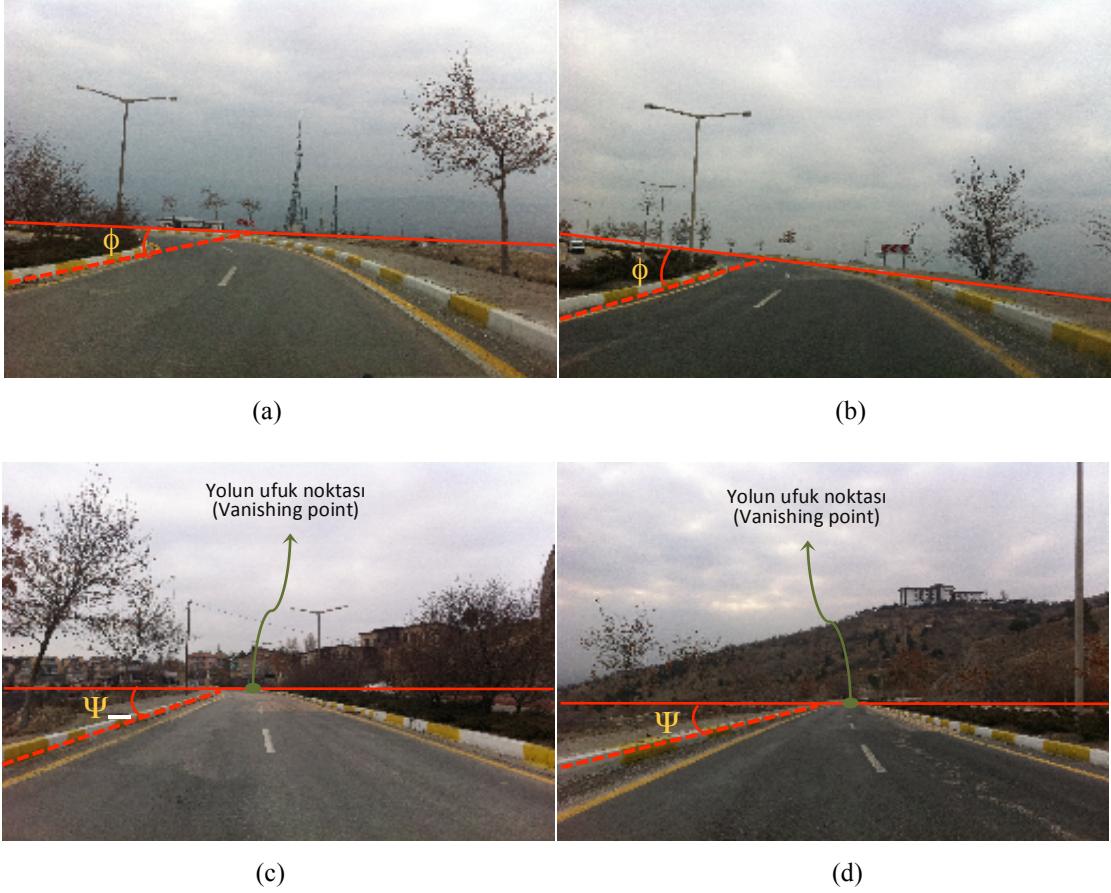
Şekil 5.6. Arka ve ön kameralardan alınan iniş/çıkış özelliklerine sahip virajlar. (a) İniş özelliğine sahip virajın ön kamera ile çekilmiş görüntüsü, (b) Yokuş özelliğine sahip virajın ön kamera ile çekilmiş görüntüsü, (c) İniş özelliğine sahip virajın arka kamera ile çekilmiş görüntüsü, (d) Yokuş özelliğine sahip virajın arka kamera ile çekilmiş görüntüsü [179].
