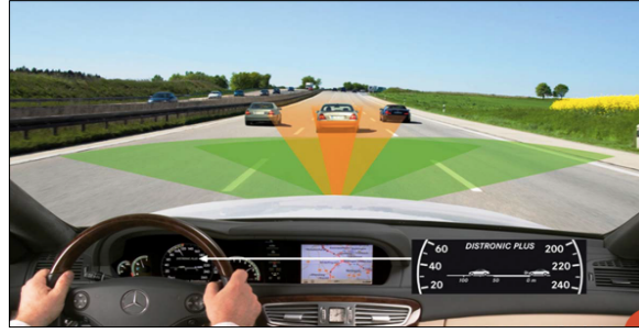
Şekil 1.2. Öndeki araçları algılayarak hız ve mesafe ayarı yapan bir SDS sistemi [5].
