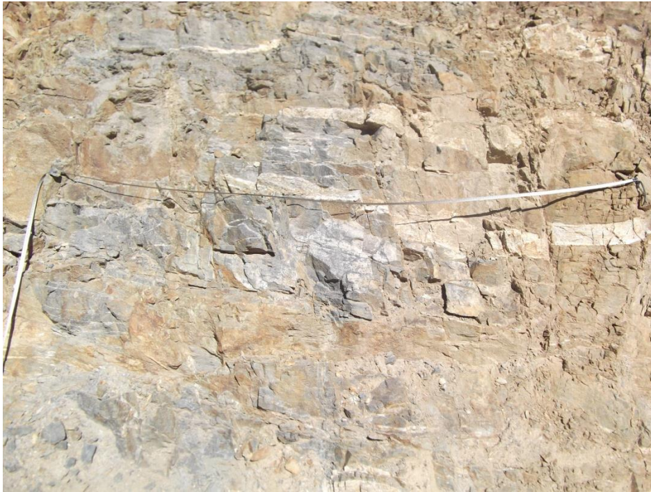
Şekil 4.1. Arazide hat etüdü yönteminin uygulanması, bakış yönü KB (E:38.446, B:38.834)
