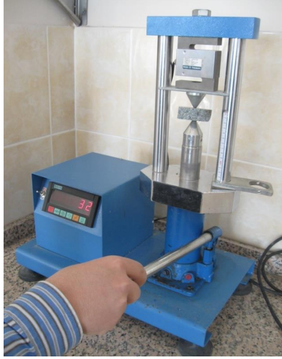
Şekil 4.23. Kömürhan Ofiyilitler'inde nokta yükü dayanım indeksinin belirlenmesi
