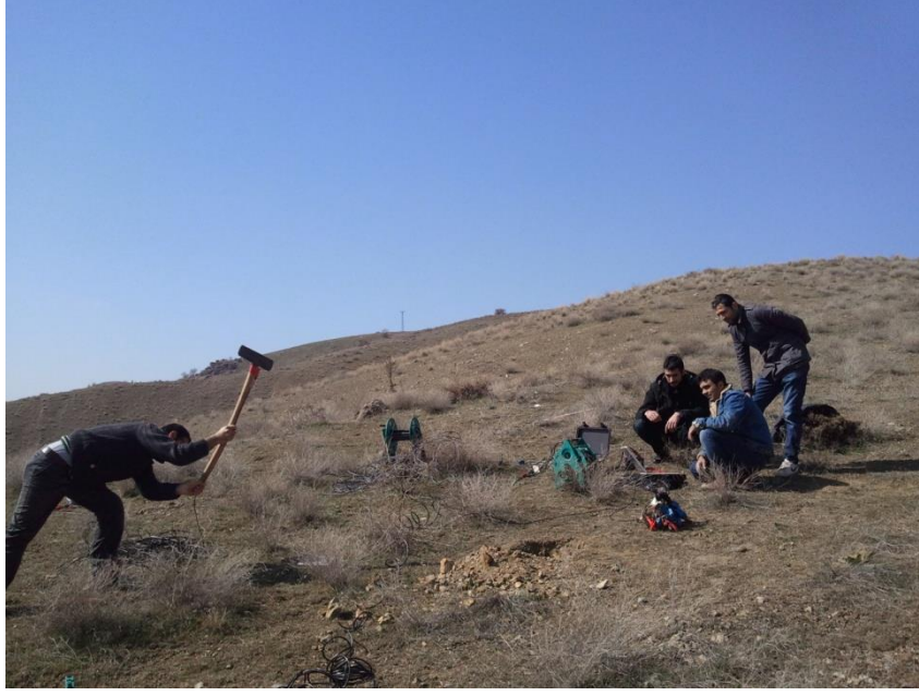
Şekil 6.4. Balyoz ile arazide sismik kırılma yönteminin uygulanması.
