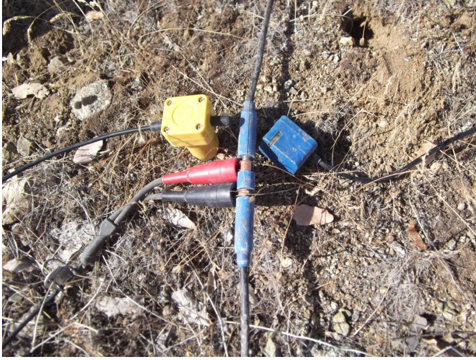
Şekil 6.2. Arazide jeofonların kullanımı
