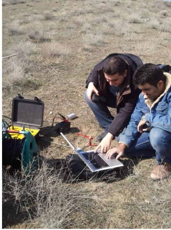
Şekil 6.13. Ras24 sismik kayıtçısı ile araziden kayıt alımı
