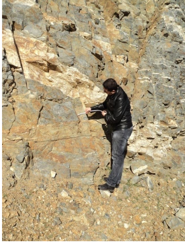
Şekil 4.5. Eklem ara uzaklığının şerit metre ile ölçümü
