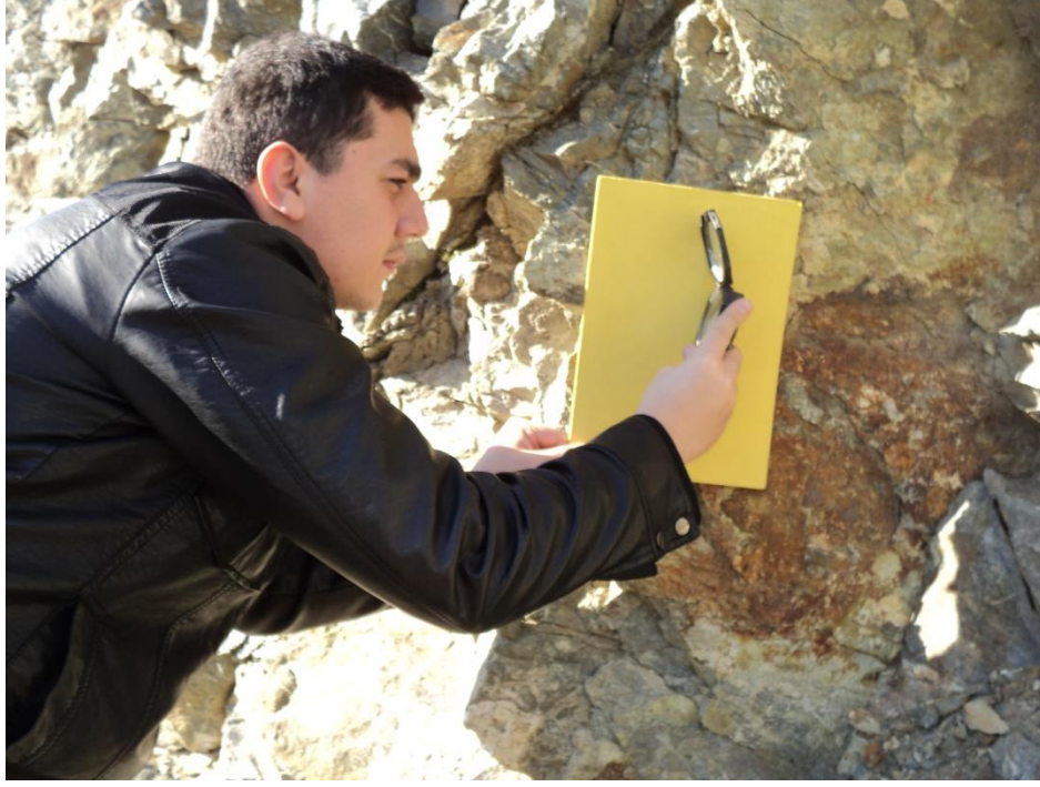
Şekil 4.3. Eklem yöneliminin pusula ile ölçümü
