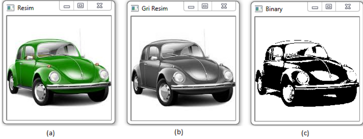
Şekil 5.20. Resmi matris olarak alma (a) orjinal resim, (b) gri resim, (c) Binary tipinde eşikleme yapılmış resim
