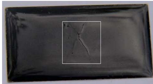
Şekil 3.5. Numunelerde Meydana Gelen Çatlaklar
