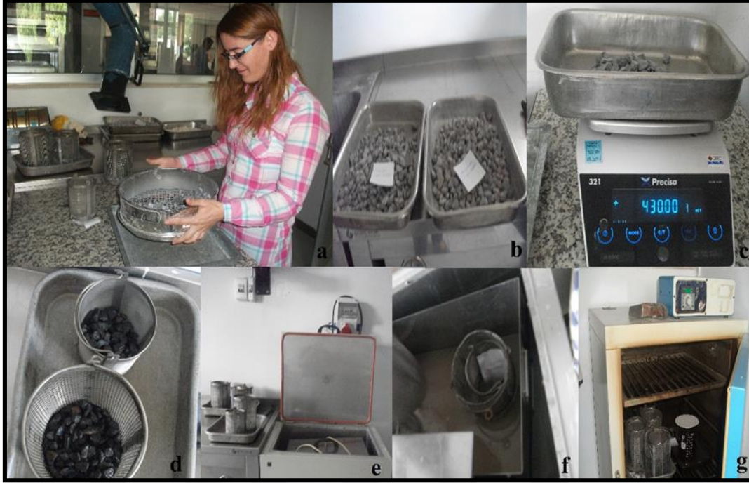
Şekil 7.5. Magnezyum sülfat deney aşamaları.
