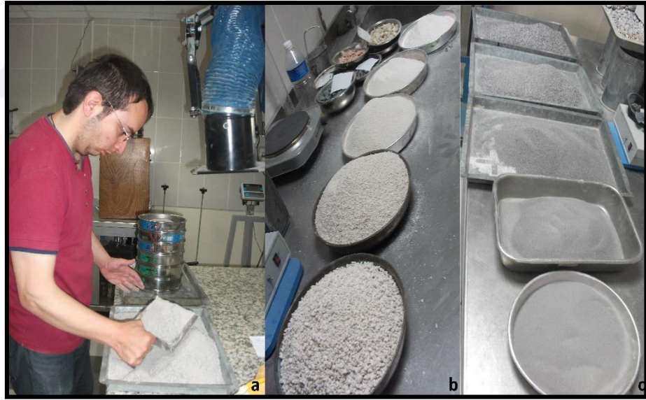
Şekil 7.6. ASTM C 1260'da belirtilen elek aralığına sınıflandırılmış numune.
