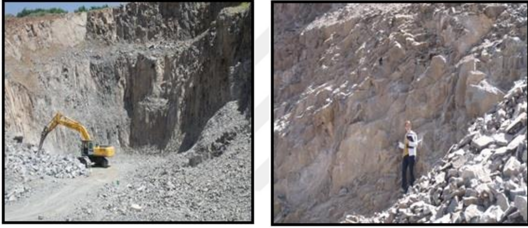
Şekil 3.5. Bingöl Şakşak tepe taş ocağında üstte soğuma çatlakları ve ince tabakalanmaların görünümü.
