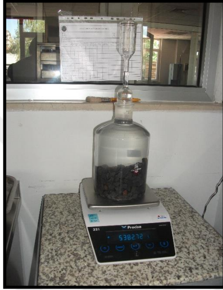
Şekil 7.4. Uygun bir piknometre örneği. 1: Cam huni, 2: İşaret çizgisi, 3: Geniş boğazlı, düz tabanlı şişeye uygun huninin alt kısmı, 4: Geniş boğazlı, düz tabanlı şişe.
