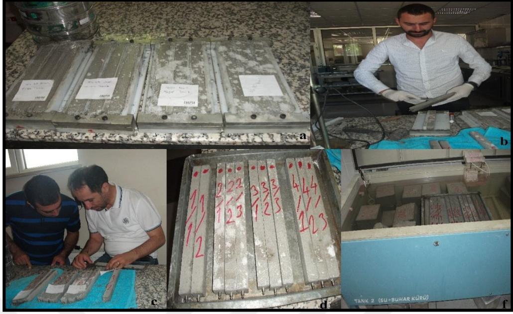
Şekil 7.8. Harç numunesinin kalıptaki ve kalıptan çıktıktan sonraki görünümü.
