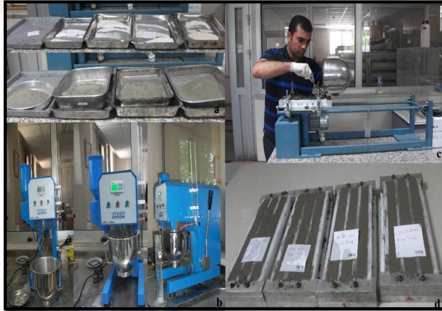
Şekil 7.7. Harç numunesinin karıştırılması, yayılması ve kalıba yerleştirilmesi.
