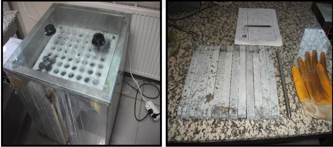
Şekil 7.9. Harç çubuklarının 80 °C su banyosunda ve çıktıktan sonraki görünümü.
