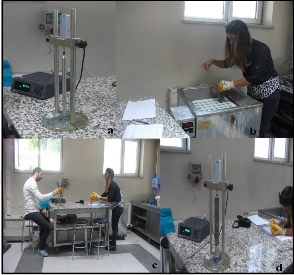
Şekil 7.10. (a) Elektronik ölçme cihazı ve referans çubuk, (b,c,d) ölçüm işlemi.
