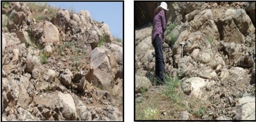
Şekil 3.5. Bingöl Şakşak tepe taş ocağında üstte soğuma çatlakları ve ince tabakalanmaların görünümü.
