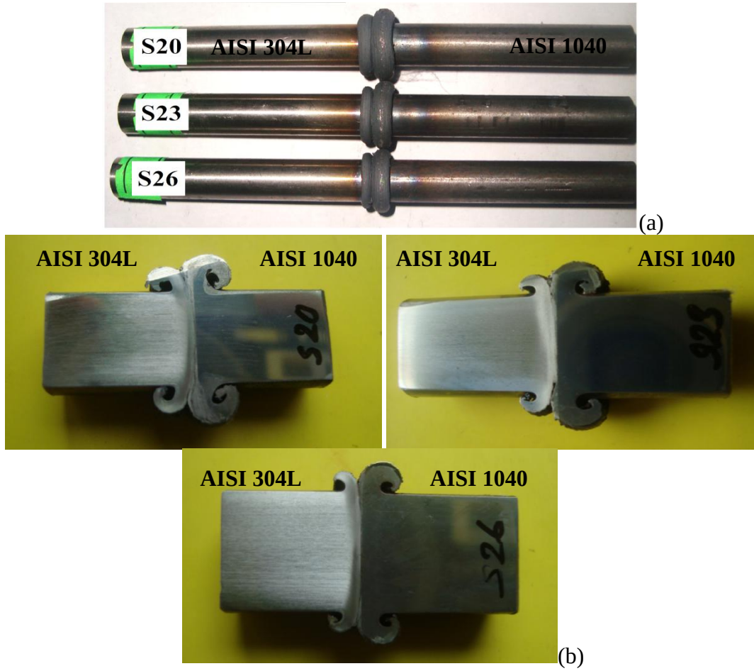
Şekil 5.10. a) S20, S23 ve S26 no’ lu numunelerin makroskopik fotoğrafı
