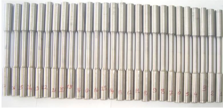
Şekil 5.30. Çekme deneyi numune resimleri
