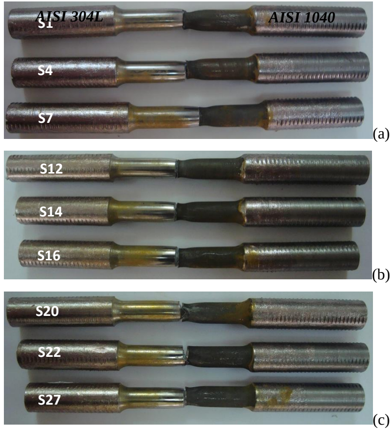
Şekil 5.49. Kaynaklı bağlantıların elektrokimyasal korozyon sonrası resimleri
