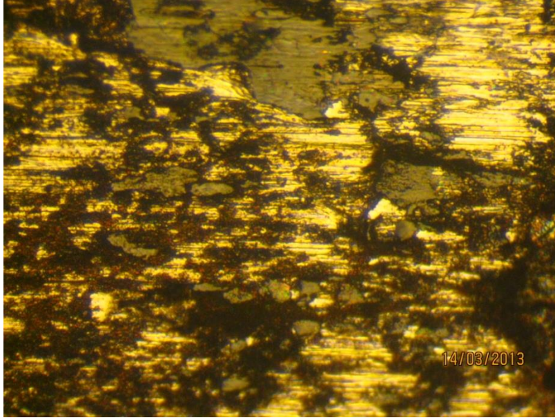
Şekil 7. N2.5 numaralı numuneye ait aşınma fotoğrafı (10x15 büyütme).
