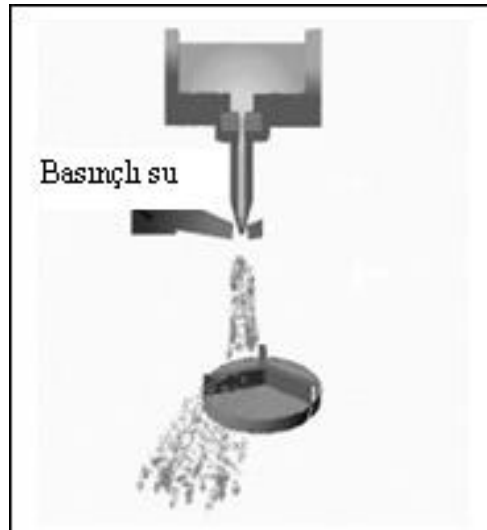
Şekil 2.8. Döner disk ile atomizasyon yöntemi [12].
