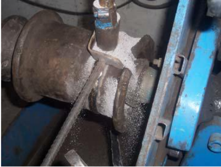
Şekil 3.4. Tozun kaynak esnasında kullanılması [19].
