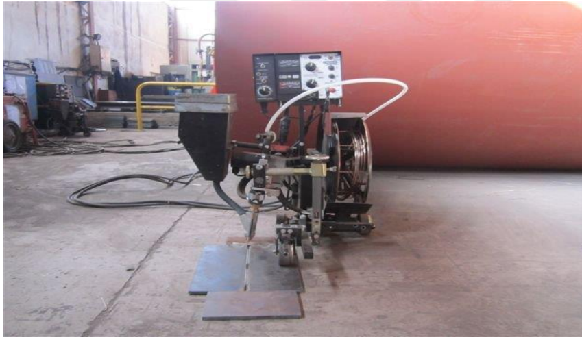
Şekil 6.2. Tozaltı kaynağı makinası ve kaynak sırasındaki fotoğrafı
