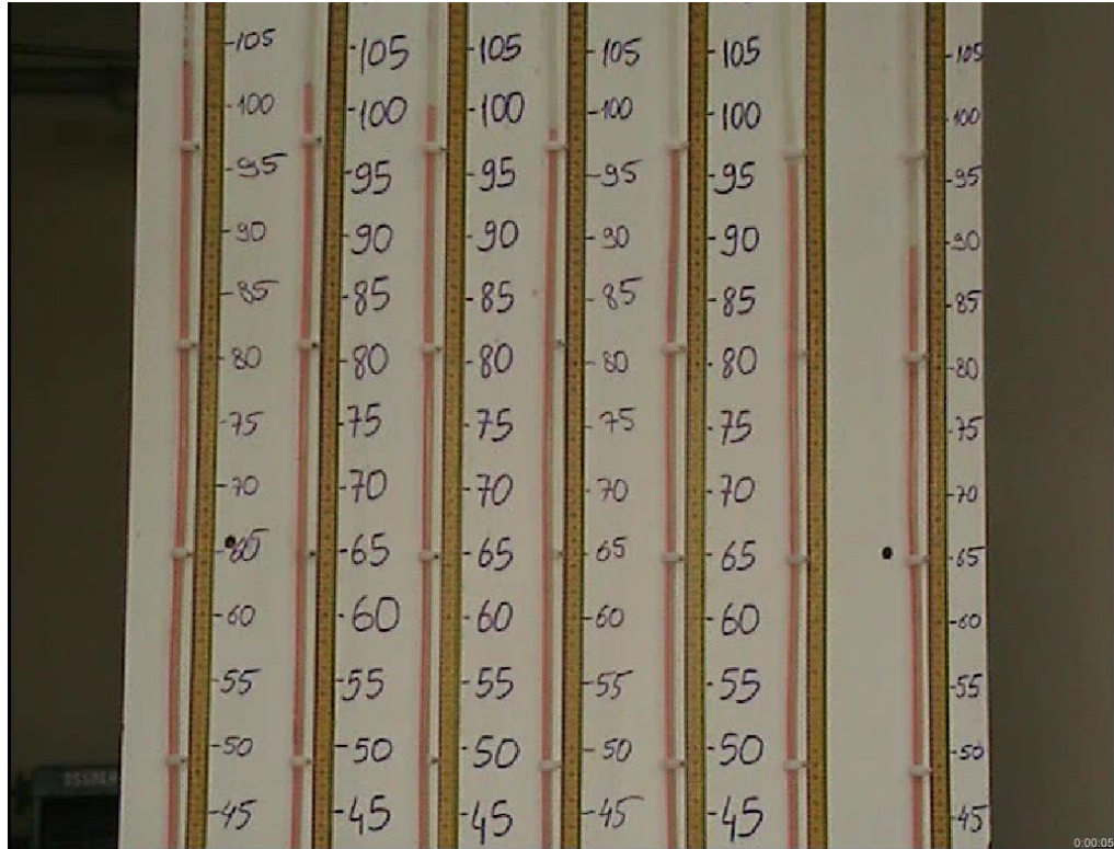
Şekil 2.2. PPRC borusu 1. deney 05. saniyede çekilen görüntü( Re=18761,94 )
